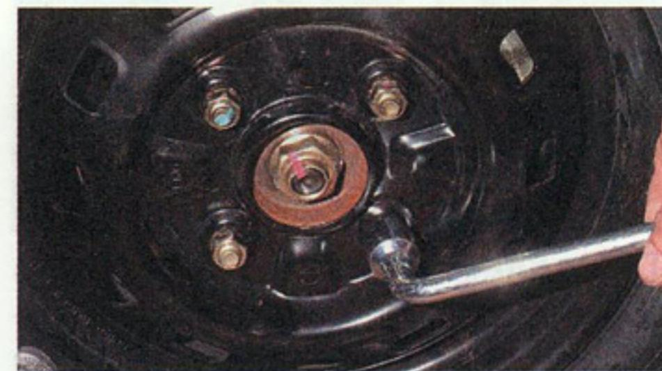
Штатным колесным ключом ослабляем затяжку гаек крепления снимаемого колеса. Устанавливаем домкрат...
