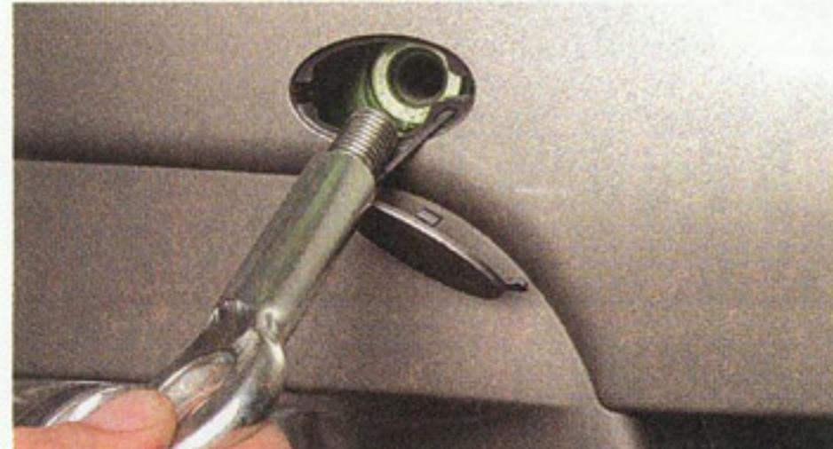
**Вворачиваем хвостовик буксирной проушины в резьбовое отверстие, расположенное в по-перечине кузова ...**
