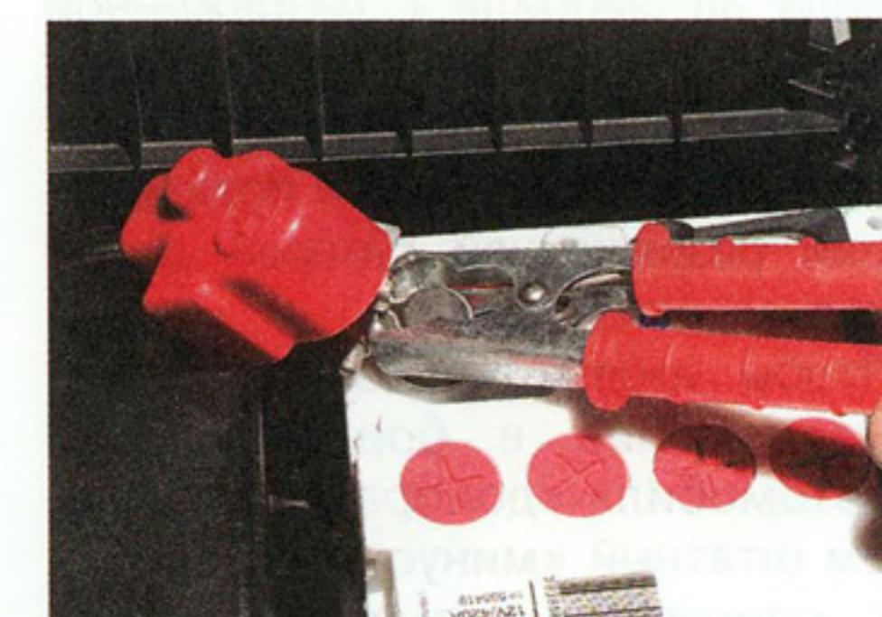
**Соединяем второй зажим красного кабеля с «плюсовым» выводом батареи автомобиля-«донора»...**
