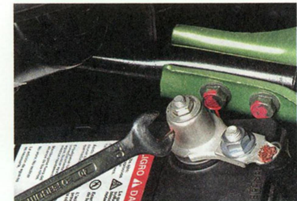
**Ключом «на 10» ослабляем затяжку гайки цангового зажима наконечника провода, соединенного с «минусовым» выводом разряженной аккумуляторной батареи.**
