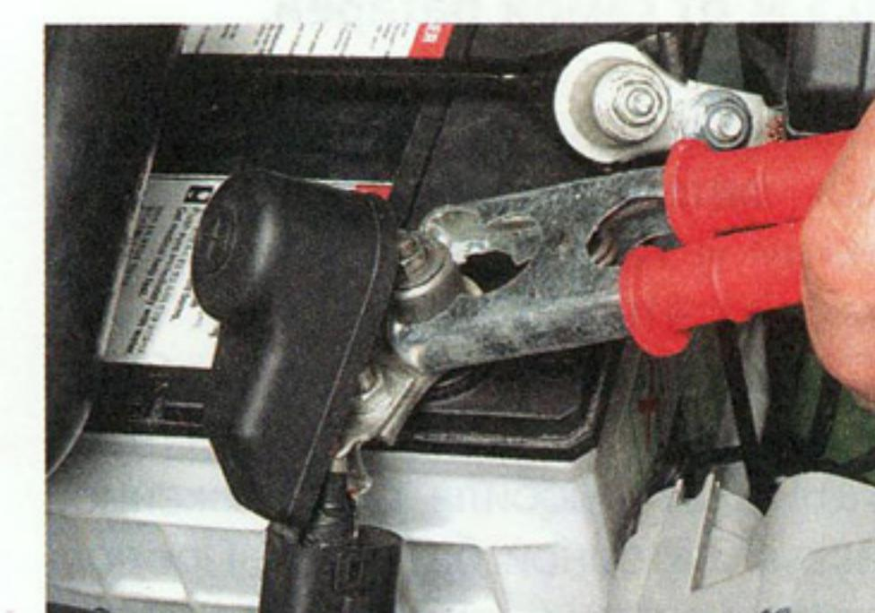
**Соединяем зажим «плюсового» (красного) соединительного кабеля с «плюсовым» выводом разряженной батареи.**
