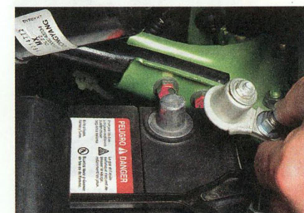
**Отсоединяем зажим провода от «минусового» вывода разряженной аккумуляторной батареи.**
