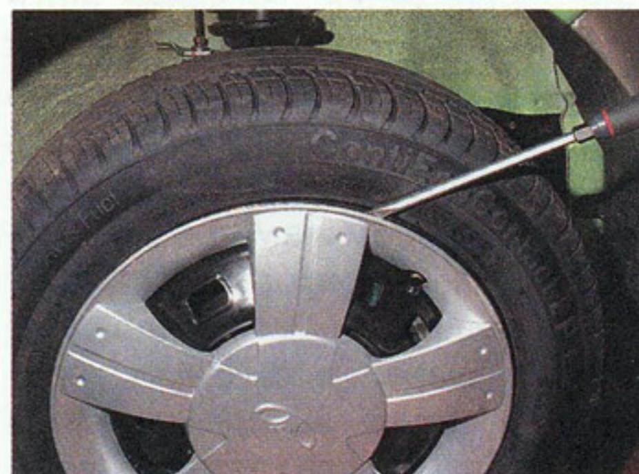
...вставляем шлицевую отвертку между колпаком и колесом. Преодолевая усилие пружинного кольца, отжимаем край колпака от колеса...
