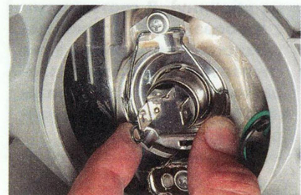
**Сжав концы пружинного фиксатора, выводим их из зацепления с выступами отражателя.**
