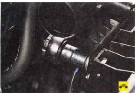
11. Выверните два болта крепления наливной горловины...
