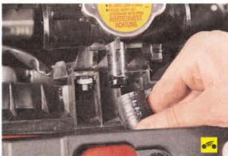
10. Отсоедините шланг термостата теплообменника (на автомобилях с вариатором).
