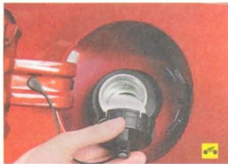
17. Выверните пробку наливной горловины.
