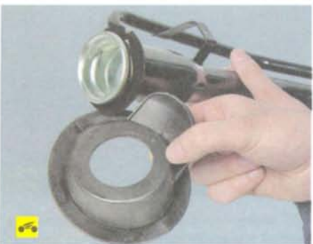
20. Сдвиньте уплотнитель с горловины наливной трубы...
