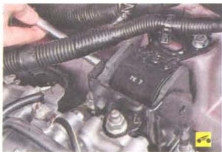
8. ...и извлеките болт из кронштейна.
