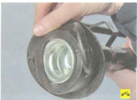
20. Сдвиньте уплотнитель с горловины наливной трубы...
