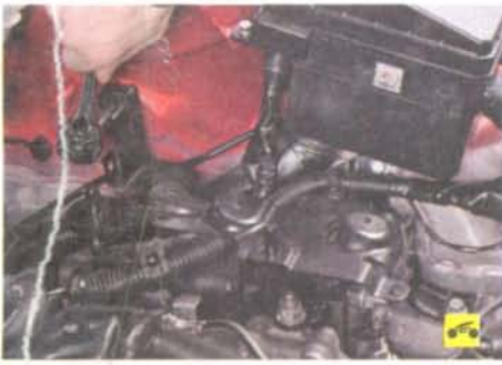
5. Выверните три болта крепления кронштейна воздушного фильтра к кузову...
