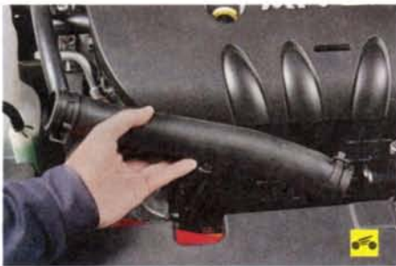
8. Аналогично отсоедините второй конец шланга от патрубка радиатора и снимите шланг.
