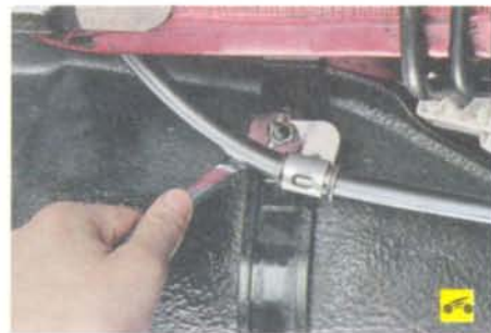
27. Отверните гайку крепления держателя левого троса привода стояночного тормоза...
