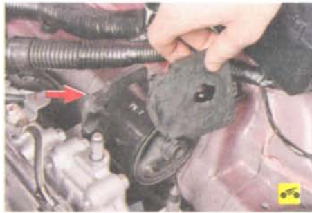
11. Снимите две резиновые шайбы опоры...
