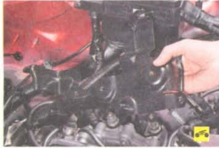
6. ...и снимите кронштейн.
