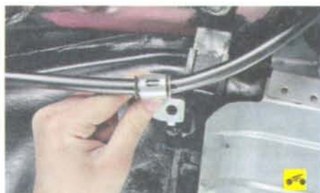
29. Отверните гайку крепления держателя правого троса привода стояночного тормоза...
