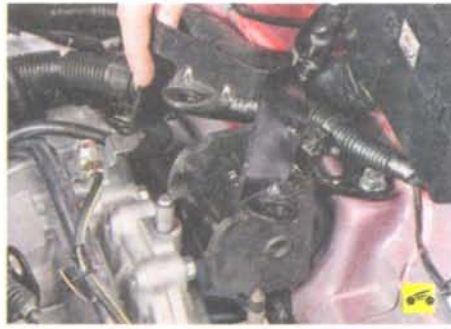
10. ...и снимите кронштейн со шпилек.
