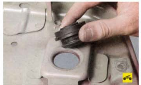
22. Замените сильно деформированные или затвердевшие подушки.
