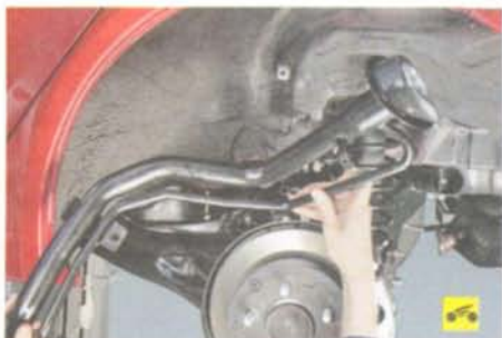
19. ...и снимите наливную трубу с автомобиля.
