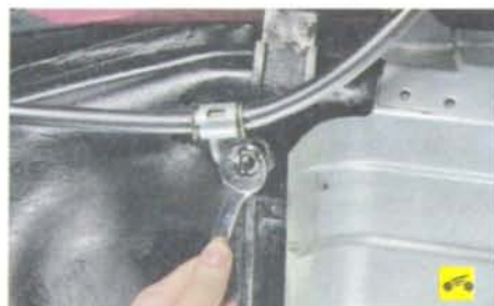
29. Отверните гайку крепления держателя правого троса привода стояночного тормоза...
