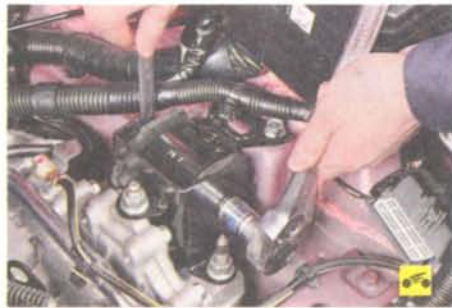
7. Отверните гайку болта крепления левой опоры двигателя к кронштейну на кузове...
