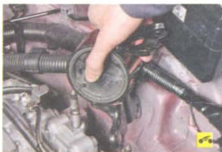
13. ...и снимите левую опору с автомобиля.
