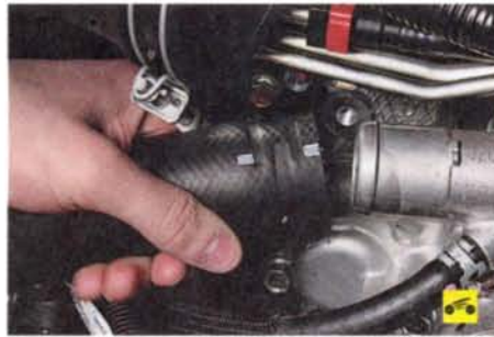
13. Отсоедините подводящий шланг радиатора от корпуса термостата.
