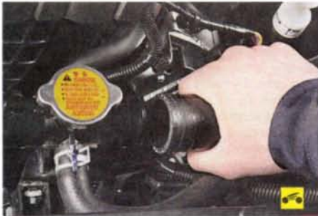
9. Отсоедините от наливной горловины шланг, подводящий охлаждающую жидкость от корпуса термостата.
