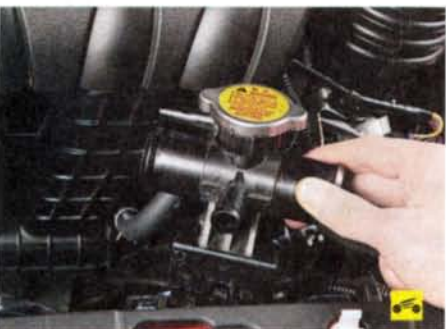
11. Выверните два болта крепления наливной горловины...
