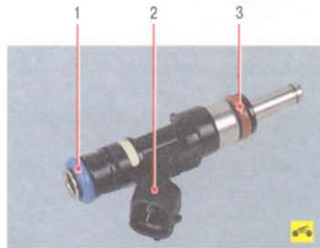
Рис. 5.43. Форсунка системы впрыска топлива: 1 – верхнее уплотнительное кольцо; 2 – штекерные выводы обмотки электромагнита; 3 – нижнее уплотнительное кольцо
