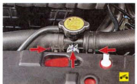
25. Установите радиатор в порядке, обратном снятию.
