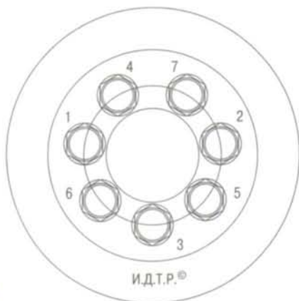
Рис 5.15. Затяжка болтов крепления маховика
