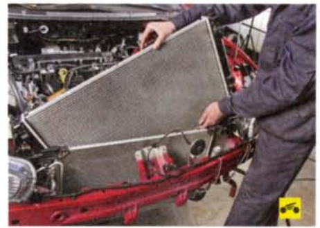
20. ...и извлеките радиатор из моторного отсека.
