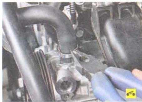
2. Ослабьте хомут крепления шланга подачи жидкости к патрубку насоса гидроусилителя рулевого управления, скав пассатижами его отогнутые ушки, сдвиньте хомут по шлангу...
