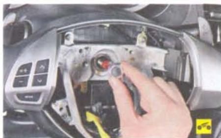
8. ...окончательно отверните гайку крепления рулевого колеса...
