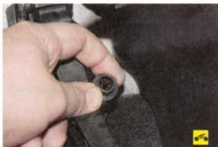
17. ...и снимите держатель щитка рулевого механизма.
