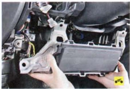
3. Снимите «коленную» подушку безопасности водителя (см. «Снятие и установка подушки безопасности для защиты коленей водителя», с. 266).
