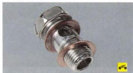
*Медные уплотнительные прокладки заменяйте новыми при каждом отсоединении трубопровода высокого давления от рулевого механизма.*
