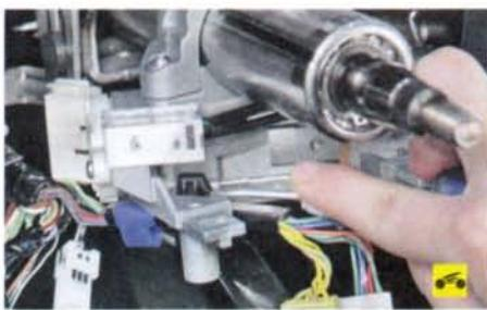
14. Сожмите фиксаторы держателя жгута проводов.
