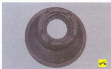
17. Осмотрите снятый уплотнитель рулевого механизма. Затвердевший или надорванный уплотнитель замените новым.
