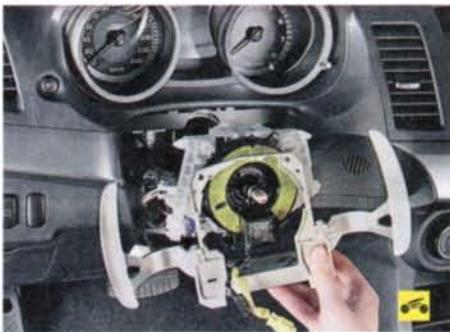
8. ...на автомобиле, оснащенном вариатором, снимите подрулевые переключатели передач...
