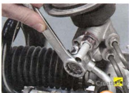
6. Выверните болт-штуцер крепления трубопровода высокого давления к рулевому механизму...
