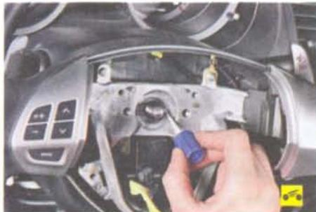
Для удобства обратной установки промаркируйте положение рулевого колеса относительно вала.
