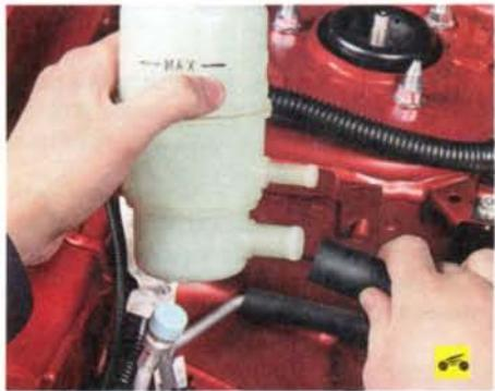
5. Аналогично отсоедините шланг подачи рабочей жидкости в насос гидроусилителя и снимите бачок.
