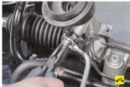
4. Ослабьте хомут крепления шланга слива жидкости из рулевого механизма, сжав пас-сатижами его отогнутые ушки. Сдвиньте хомут по шлангу...
