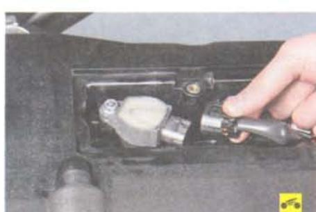
5. Отсоедините колодки с проводами от катушек зажигания (см. «Снятие и установка катушек зажигания», с. 201).
