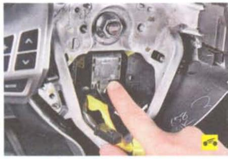
4. Нажмите на фиксатор колодки жгута проводов...
