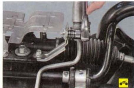
8. Выверните болт крепления трубопровода высокого давления к кронштейну подрамника...
