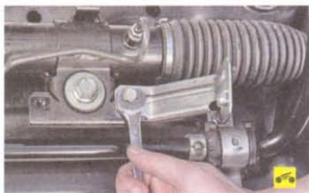
12. Выверните болт крепления кронштейна трубопровода высокого давления к рулевому механизму и снимите кронштейн.
