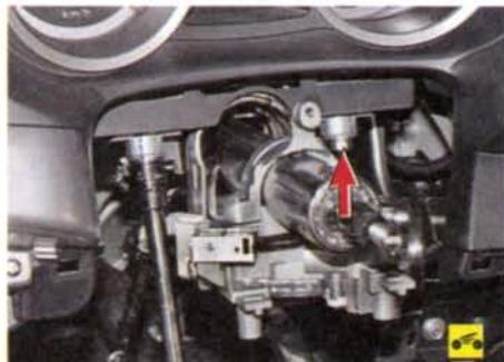
21. Выверните два болта крепления рулевой колонки к каркасу панели приборов и снимите рулевую колонку.
