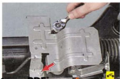
10. Выверните два болта крепления термоэкрана к рулевому механизму...
