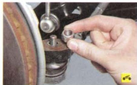
5. Окончательно отверните гайку крепления шарового пальца.
