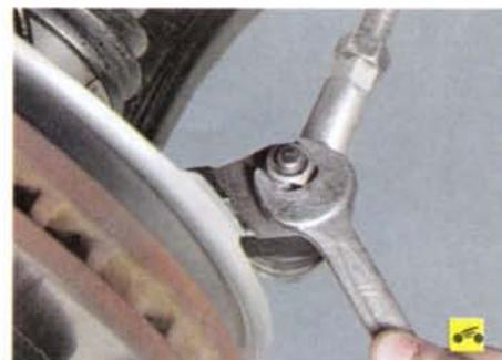
3. Ослабьте затяжку гайки крепления шарового пальца наконечника к рычагу поворотного кулака.
