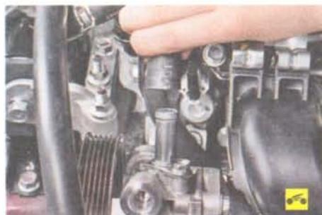
3. ...и отсоедините шланг от патрубка. Слейте жидкость из бачка в заранее подготовленную емкость.
