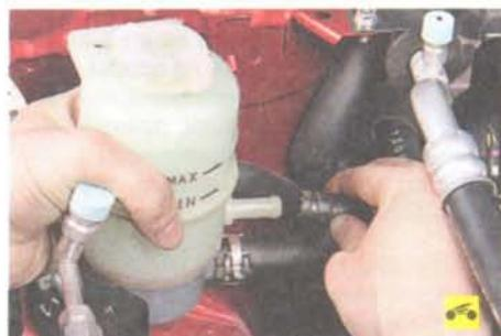
4. Аналогично отсоедините от бачка шланг слива жидкости из рулевого механизма и опустите конец шланга в заранее подготовленную емкость.
