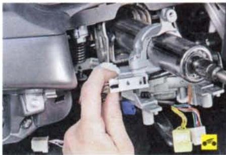
11. Сожмите фиксатор колодки жгута проводов блока иммобилизатора...
