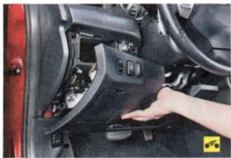
2. Снимите левую нижнюю накладку панели приборов (см. «Снятие и установка панели приборов», с. 249).
