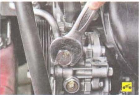
5. Выверните болт-штуцер крепления трубопровода высокого давления к штуцеру насоса гидроусилителя рулевого управления и отсоедините трубопровод.
