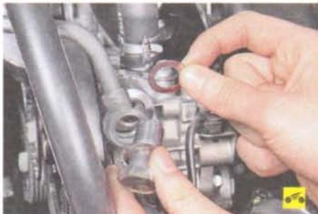
**Медные уплотнительные кольца в соединении трубопровода высокого давления с насосом гидроусилителя рулевого управления при сборке замените новыми.**
