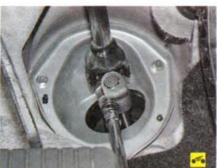
20. Выверните стяжной болт хомута рулевого вала и слегка разожмите хомут отверткой.
