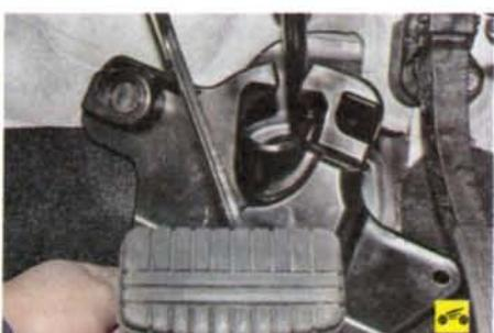
19. ...и снимите щиток рулевого механизма.
