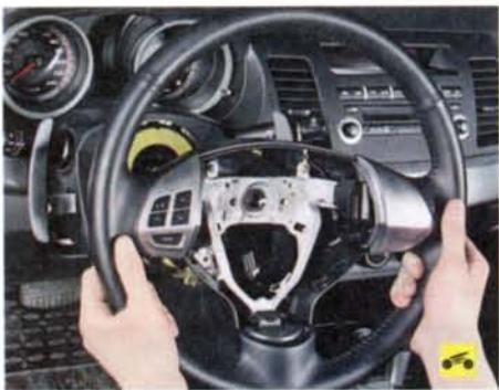
9. ...и снимите рулевое колесо.
