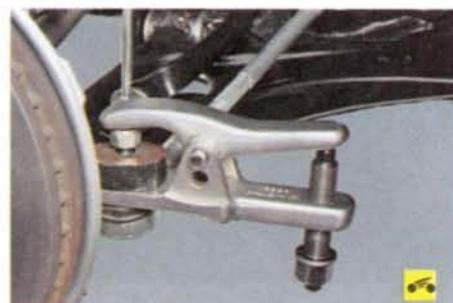
4. Установите съемник шаровых шарниров и выпрессуйте палец из бобышки поворотного рычага.
