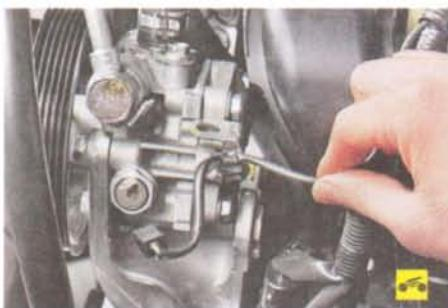
4. Извлеките держатель провода датчика давления из отверстия в кронштейне насоса гидроусилителя и отведите провод в сторону.
