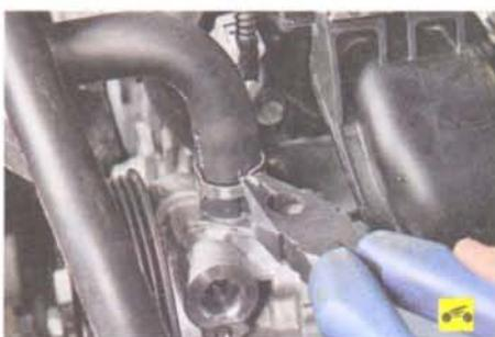
7. Ослабьте хомут крепления шланга подачи жидкости к патрубку насоса гидроусилителя рулевого управления, сжав пассатижами его отогнутые ушки, сдвиньте хомут по шлангу...
