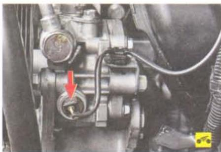
3. Отсоедините провод от датчика давления в системе гидроусилителя рулевого управления.
