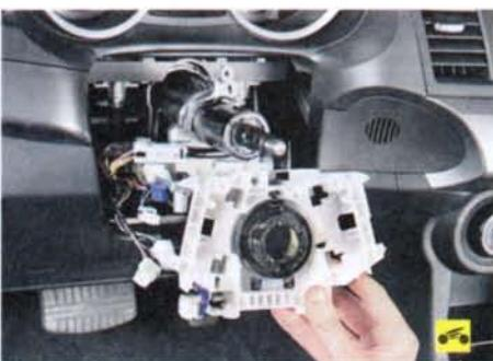
10. ...и снимите соединитель подрулевых переключателей (см. «Замена подрулевых переключателей», с. 214).
