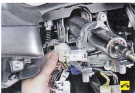
13. Сожмите фиксатор и отсоедините колодку жгута проводов от разъема выключателя (замка) зажигания.
