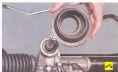
16. Снимите с рулевого механизма уплотнитель.
