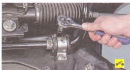
13. Ослабьте затяжку болтов скоб подушек стабилизатора поперечной устойчивости.
