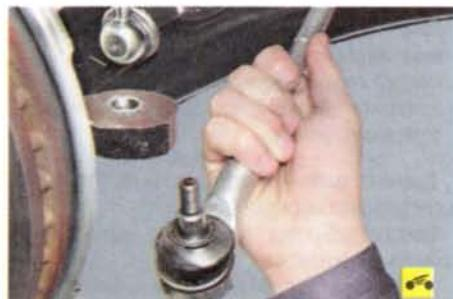
2. Ослабьте затяжку контргайки наконечника рулевой тяги.
