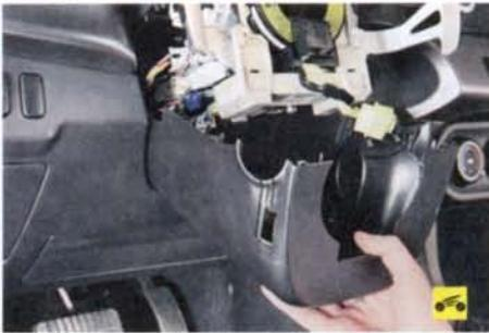
6. ...и нижний кожухи рулевой колонки (см. «Снятие и установка кожухов рулевой колонки», с. 253).
