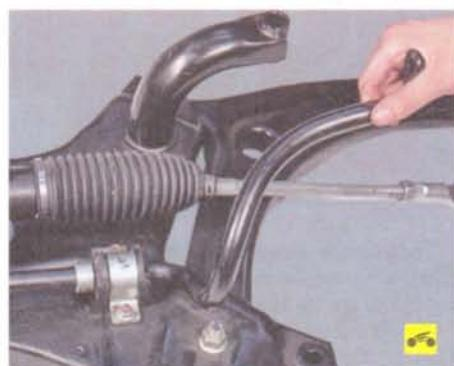
14. Поверните штангу стабилизатора, чтобы она не мешала снятию с подрамника рулевого механизма.
