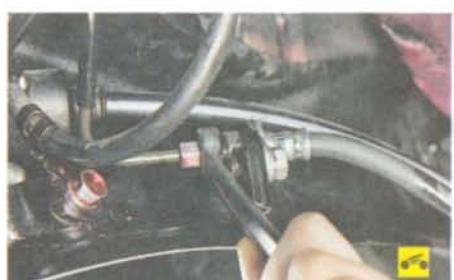
1. Отверните гайку крепления тормозной трубы к заднему наконечнику переднего шланга...
