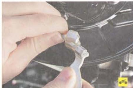
1. Отсоедините наконечник левого заднего троса от разжимного рычага задней колодки тормозного механизма (см. «Замена колодок стояночного тормоза», с. 176).
