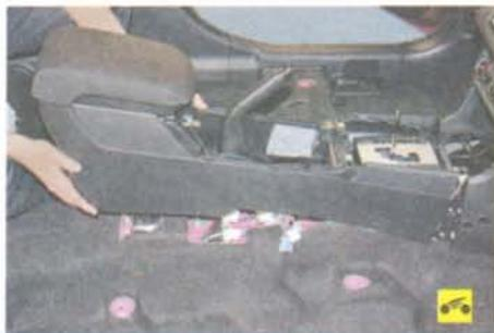
2. Если количество щелчков не укладывается в приведенный выше интервал, снимите облицовку тоннеля пола (см. «Снятие и установка облицовки тоннеля пола», с. 247)...
