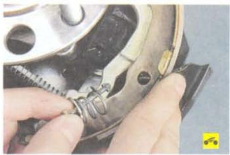
12. ...и снимите стержень вместе с прижимной пружиной и чашкой пружины.
