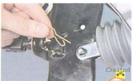
6. ...извлеките его из отверстия пальца вилки толкателя вакуумного усилителя...
