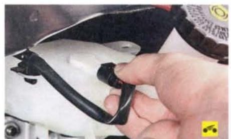
1. Нажмите на фиксатор колодки проводов в бачке главного тормозного цилиндра...
