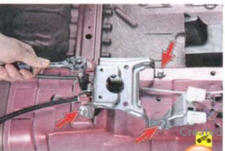
20. Выверните четыре болта, которыми крепится кронштейн рычага привода стояночного тормоза к тоннелю пола...
