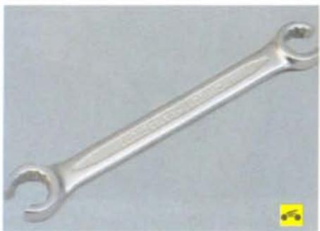
...а также специальный ключ для гаек тормозных трубопроводов «на 10».
