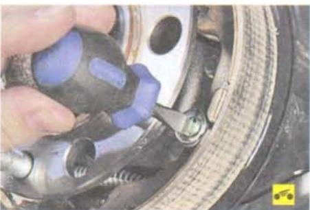
11. Нажмите на стержень прижимной пружины задней тормозной колодки, поверните стержень на 90°...
