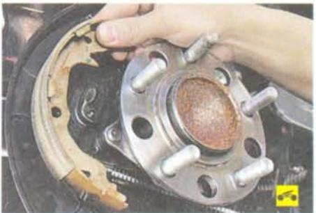
16. Снимите переднюю колодку стояночного тормоза.
