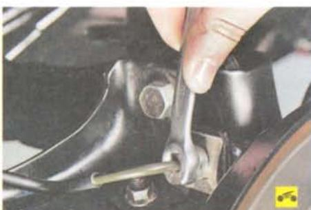
18. Для замены **заднего шланга тормозного механизма заднего колеса** отверните гайку крепления тормозной трубы к переднему наконечнику шланга...
