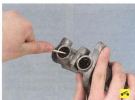
5. Если в процессе эксплуатации наблюдалась утечка тормозной жидкости через соединительные втулки, подденьте втулки отверткой...
