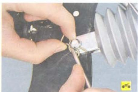
5. В салоне под панелью приборов, поддав отверткой пружинный шплинт...
