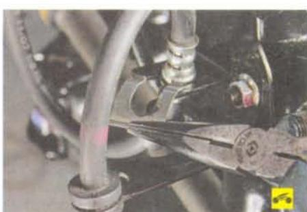
7. Снимите запорную скобу держателя шланга на кронштейне амортизаторной стойки передней подвески...
