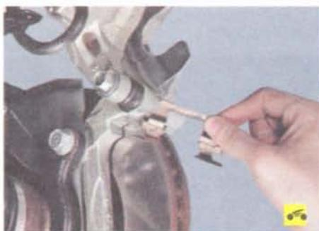
7. Снимите с направляющей колодок две фиксирующие пружины.
