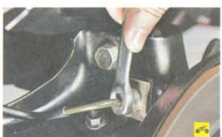
2. ...и гайку крепления тормозной трубы к переднему наконечнику заднего шланга.
