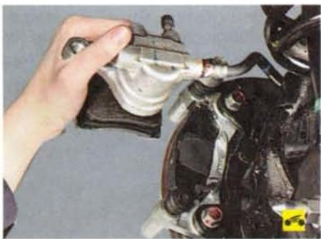
4. ...и приподнимите суппорт вверх вместе с наружной тормозной колодкой.
