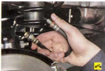
2. Снимите задний шланг заднего тормозного механизма (см. «Замена тормозных шлангов», с. 170).
