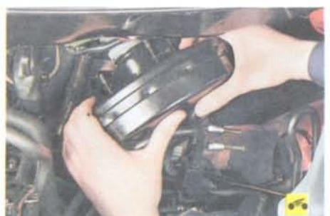
11. Сдвиньте вакуумный усилитель в сторону передней части автомобиля до выхода шпилек крепления из отверстий в щите передка...
