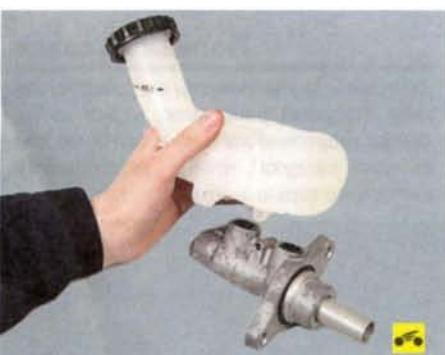
4. ...и снимите бачок, извлекая его патрубки из соединительных втулок.
