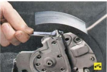
17. Отверните регулировочную гайку наконечника переднего троса стояночного тормоза...
