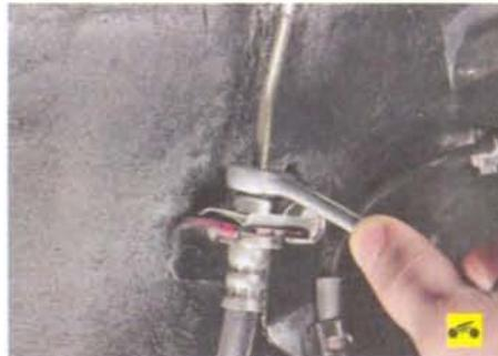
2. Отверните гайку крепления трубы...
