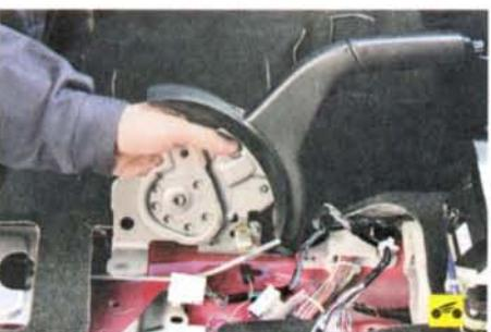
19. Снимите рычаг привода стояночного тормоза (см. «Замена рычага привода стояночного тормоза», с. 180).
