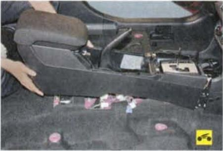
16. Снимите облицовку тоннеля пола (см. «Снятие и установка облицовки тоннеля пола», с. 247).
