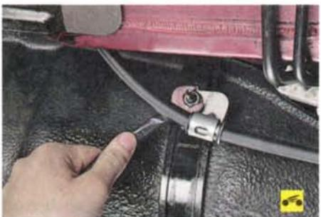
12. Отверните гайку крепления кронштейна оболочки левого заднего троса стояночного тормоза...
