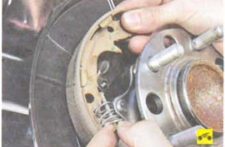
15. ...и снимите стержень вместе с прижимной пружиной и чашкой пружины.
