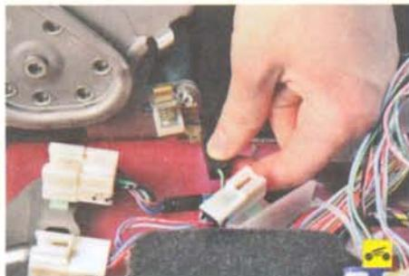
2. Отсоедините колодку провода от выключателя сигнальной лампы включения стояночного тормоза и аварийного падения уровня тормозной жидкости.
