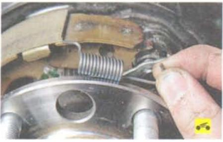
5. Аналогично снимите стяжную пружину передней тормозной колодки.
