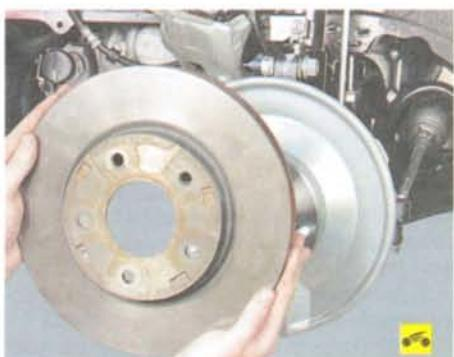
8. Снимите тормозной диск со ступицы переднего колеса.
