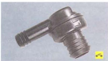
Во впускное отверстие вакуумного усилителя установлен обратный клапан. Он удерживает в усилителе разрежение при его падении во впускном коллекторе и препятствует попаданию топливовоздушной смеси в вакуумный усилитель.
