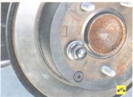
Для предотвращения падения диска навинтите гайку на одну из шпилек крепления колеса.
