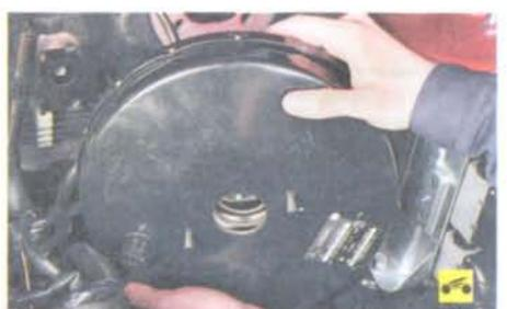
12. ...и снимите вакуумный усилитель.
