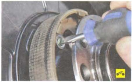
14. Нажмите на стержень прижимной пружины передней тормозной колодки, поверните стержень на 90°...
