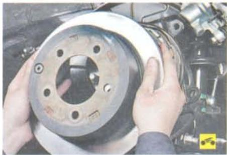
4. ...и снимите тормозной диск.
