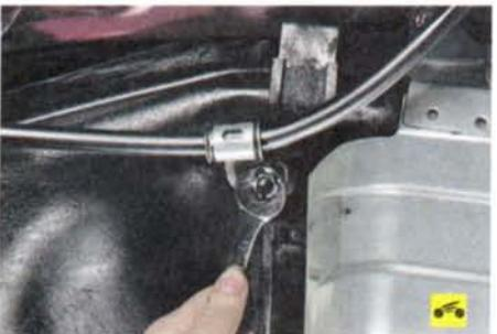
14. Отверните гайку крепления к кронштейну топливного бака кронштейна оболочки правого заднего троса стояночного тормоза...
