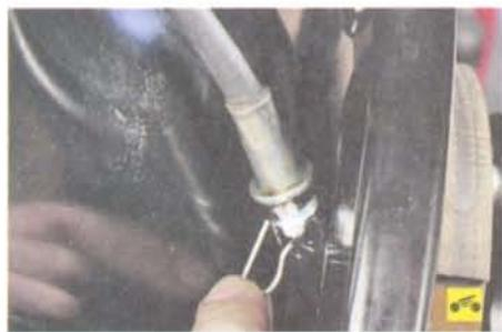
3. ...и снимите фиксатор крепления оболочки троса к кронштейну тормозного щита.
