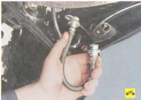
17. ...выньте наконечник из кронштейна на продольном рычаге и снимите шланг.
