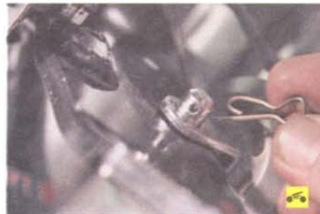
6. В салоне под панелью приборов, поддев отверткой, извлеките пружинный шплинт из отверстия пальца вилки толкателя вакуумного усилителя...
