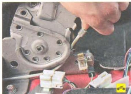
3. Отсоедините от рычага наконечник переднего троса привода стояночного тормоза (см. «Замена тросов привода стояночного тормоза», с. 178).
