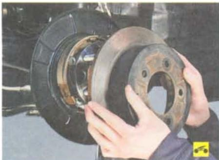
2. Снимите тормозной диск (см. «Замена тормозного диска тормозного механизма заднего колеса», с. 175).
