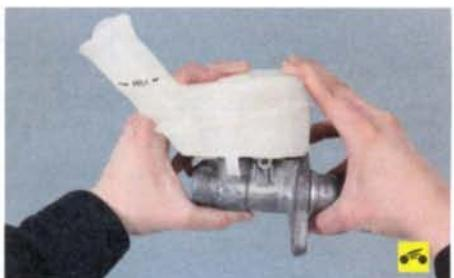
8. Затем установите бачок, вставив его патрубки в соединительные втулки усилием руки до упора.
