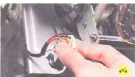
4. Нажмите на фиксатор колодки жгута проводов выключателя стоп-сигнала...
