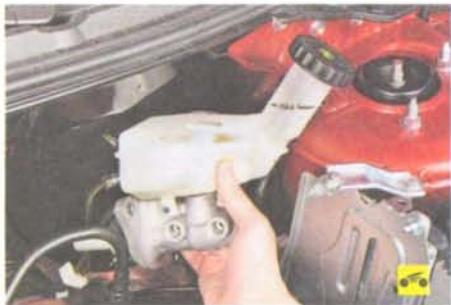
8. ...и снимите главный тормозной цилиндр в сборе с бачком.
