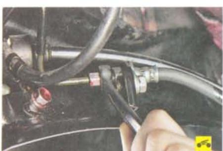
15. Отверните гайку крепления тормозной трубы к заднему наконечнику шланга...
