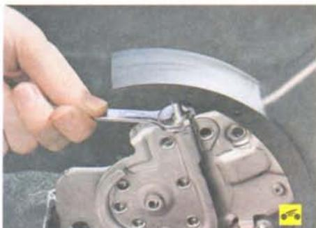
3. ...и вращением регулировочной гайки наконечника троса добейтесь нужного количества щелчков.
