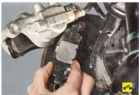
5. Снимите с направляющей внутреннюю тормозную колодку...
