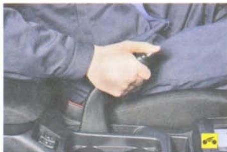
1. Поднимите рычаг стояночного тормоза вверх до упора, при этом вы должны услышать 3–5 щелчков храпового устройства.
