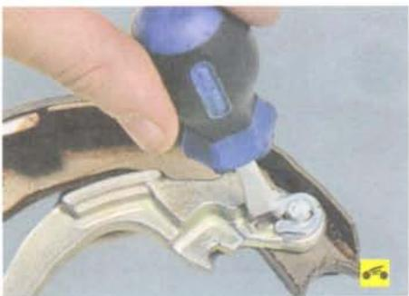
17. Снимите с задней тормозной колодки разжимной рычаг, для чего разожмите отверткой стопорное кольцо.
