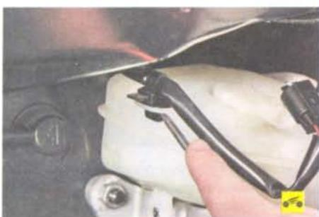
3. Сожмите ушки держателя проводов датчика падения уровня тормозной жидкости и отсоедините держатель от кронштейна бачка главного тормозного цилиндра.
