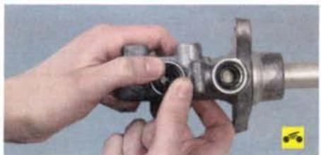
7. Перед установкой бачка вставьте в отверстия главного тормозного цилиндра новые соединительные втулки.
