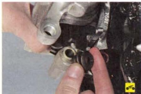
При каждой замене тормозных колодок в обязательном порядке проверяйте состояние защитных резиновых чехлов направляющих пальцев, а также легкость перемещения суппорта относительно направляющей тормозных колодок. Если перемещение затруднено, смажьте консистентной смазкой направляющий палец и его чехол.
