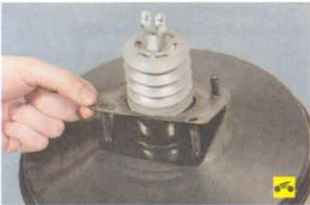
13. Если сняли вакуумный усилитель для замены, снимите с него шпилек уплотнительную прокладку и переставьте ее на новый усилитель. Сильно обжатую или надорванную прокладку замените.
