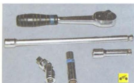
Для отворачивания труднодоступных гаек крепления вакуумного усилителя вам понадобится набор торцовых головок, удлинителей и воротков, подобный изображенному на фото.
