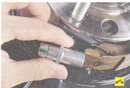
9. ...и снимите регулировочное устройство.
