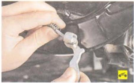
13. Выведите из зацепления с разжимным рычагом трос и снимите заднюю колодку стояночного тормоза.
