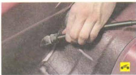
26. ...и выньте тросы вместе с уплотнителем из отверстий в кузове.
