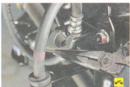
3. Снимите запорную скобу держателя шланга на кронштейне амортизаторной стойки передней подвески...
