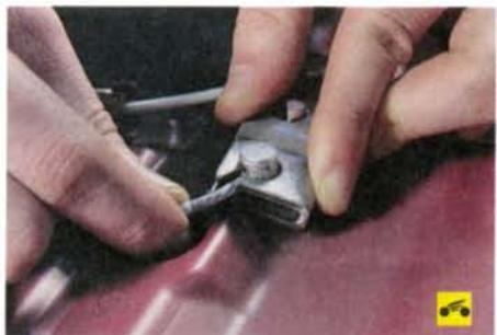
22. Поверните наконечники задних тросов в отверстиях уравнителя до совмещения тросов с прорезями в уравнителе...
