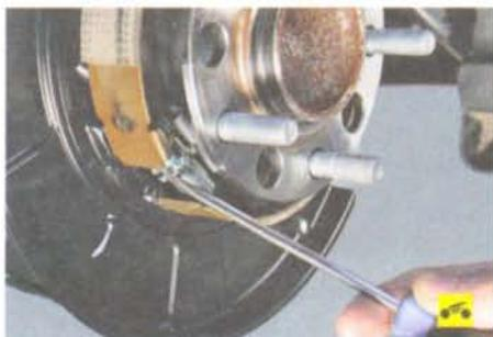
7. ...и вращайте гайку регулировочного устройства стояночного тормоза до полного затормаживания тормозного диска колодками стояночного тормоза (для наглядности тормозной диск снят).
