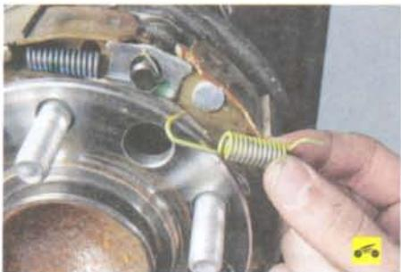
4. ...и снимите пружину (она окрашена в желтый цвет).
