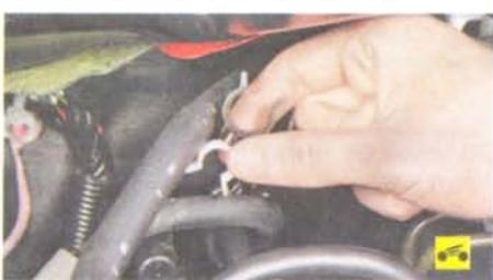
1. Снимите со шлангов пластмассовый соединитель.
