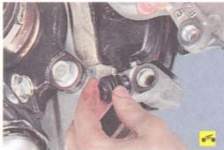
**При каждой замене тормозных колодок в обязательном порядке проверьте состояние резиновых защитных чехлов направляющих пальцев и перемещение суппорта относительно направляющей тормозных колодок. Если перемещение затруднено, смажьте консистентной смазкой направляющие пальцы суппорта.**
