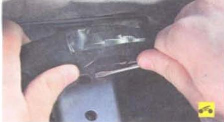
3. Сожмите с помощью отвертки ушки держателя жгута проводов в верхней части кронштейна педали тормоза и отсоедините держатель от кронштейна.
