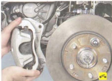
6. Снимите суппорт в сборе, не отсоединяя тормозной шланг...
