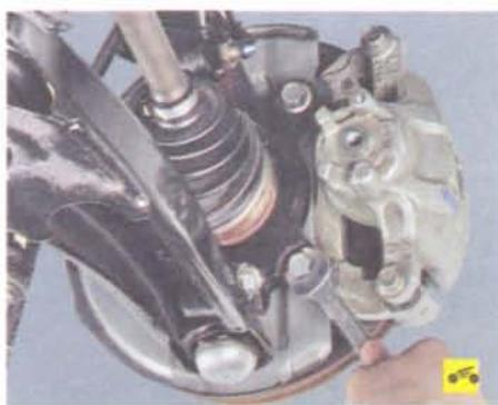
3. Выверните два болта крепления направляющей колодок к поворотному кулаку...
