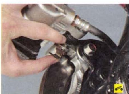
8. ...и снимите с направляющей колодок нижнюю и верхнюю фиксирующие пружины.
