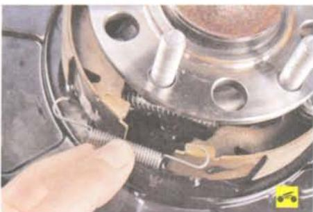
10. Снимите нижнюю стяжную пружину.
