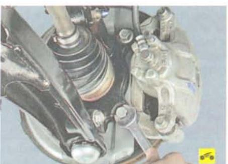
5. Выверните два болта крепления направляющей колодок к поворотному кулаку.
