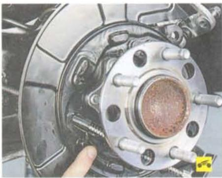
18. Нанесите тугоплавкую смазку на точки контакта колодок стояночного тормоза со щитом тормозного механизма.
