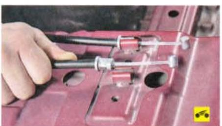
25. Выберите фиксаторы оболочек задних тросов из кронштейнов на кузове...
