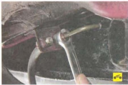
12. Для замены переднего шланга тормозного механизма заднего колеса отверните гайку крепления тормозной трубы к переднему наконечнику шланга...
