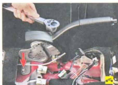
4. Выверните три болта крепления рычага привода стояночного тормоза к кронштейну...
