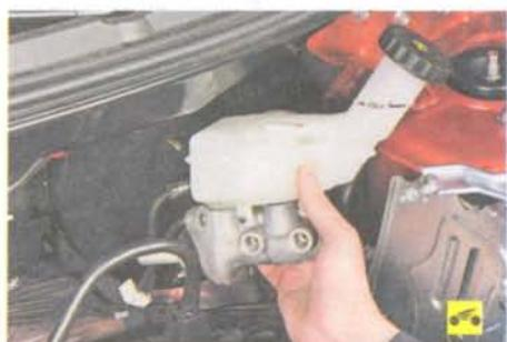
4. Снимите главный тормозной цилиндр (см. «Замена главного тормозного цилиндра», с. 167).
