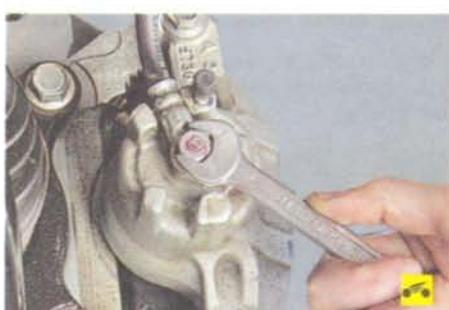
5. Выверните болт-штуцер крепления нижнего наконечника шланга к рабочему цилиндуру тормозного механизма переднего колеса.
