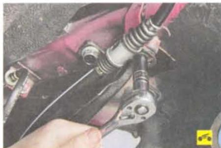
4. Выверните болт крепления кронштейна оболочки троса к кузову.
