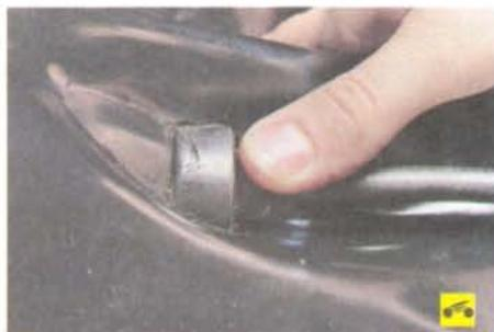
6. Протолкните втулку оболочки троса в отверстие продольного рычага подвески...
