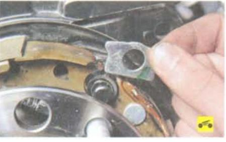
6. Снимите фиксирующую пластину...
