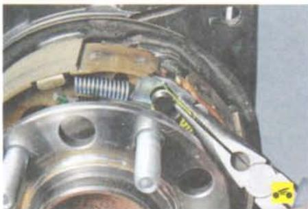
3. Выведите верхний конец стяжной пружины задней колодки из зацепления с опорным стержнем...
