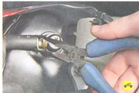
2. Сожмите ушки хомута крепления вакуумного шланга к штуцеру обратного клапана, сдвиньте хомут по шлангу...
