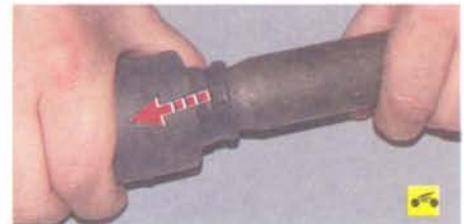
...и снять демпфер с вала, преодолевая трение массива резины демпфера о вал.
