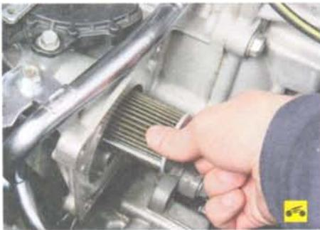
18. Извлеките фильтр рабочей жидкости из корпуса вариатора.
