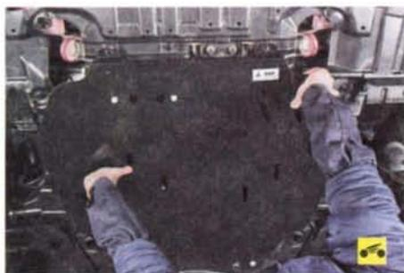
14. Вывернув четыре болта, снимите защиту картера двигателя...
