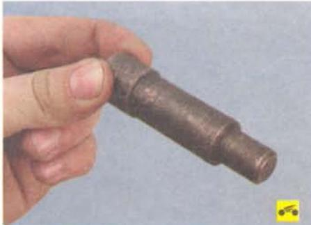
...и оправка для центрирования ведомого диска. Подойдет и имеющаяся в продаже оправка для переднеприводных автомобилей ВАЗ.
