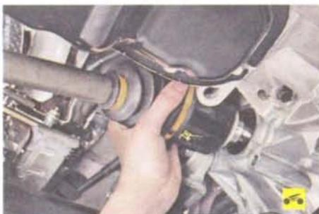
15. ...извлеките внутренний шарнир привода из коробки передач...
