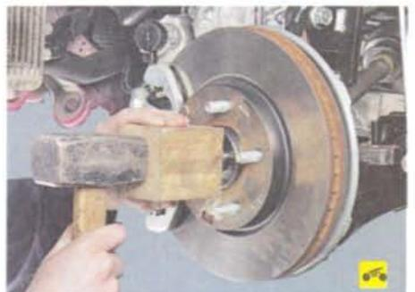
При затрудненном выведении хвостовика наружного шарнира аккуратно, не повреждая резьбы, выбейте его из ступицы молотком через выколотку или деревянный брусок подходящего размера.
