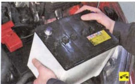
5. Снимите аккумуляторную батарею (см. «Снятие и установка аккумуляторной батареи», с. 187)...
