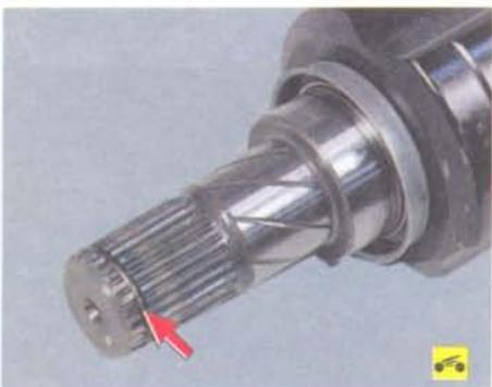
Заменяйте стопорные кольца хвостовиков внутренних шарниров новыми при каждом снятии приводов с авто-
