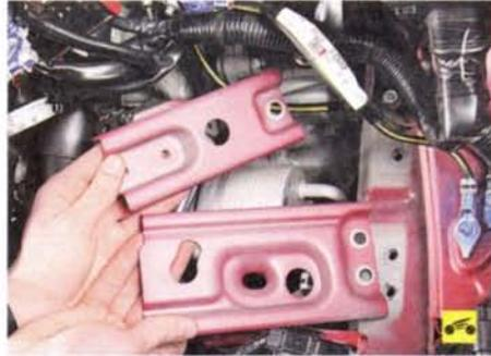
7. ...и полку крепления аккумуляторной батареи (см. «Снятие и установка полки крепления аккумуляторной батареи», с. 254).
