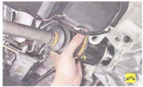
42. Отсоедините от коробки передач приводы передних колес (см. «Снятие
