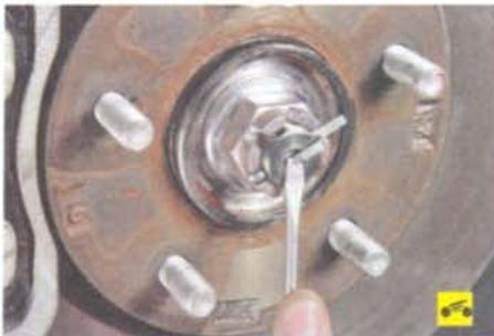
4. Разогните усики шплинта гайки ступицы...
