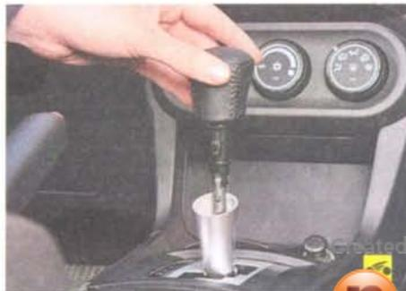
9. Снимите рукоятку рычага селектора вариатора.
