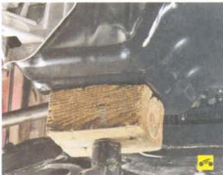
43. Установите под двигатель надежную опору или вывесите его с помощью грузоподъемного механизма.
