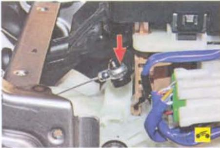
16. Отсоедините наконечник троса привода управления вариатором от рычага селектора.
