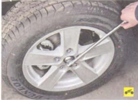
7. Ослабьте затяжку гайки ступицы переднего колеса.
