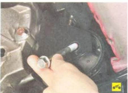
46. Извлеките болт крепления передней опоры силового агрегата.
