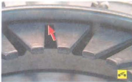
12. Внешним осмотром оцените состояние опорных колец нажимной пружины. Кольца не должны иметь трещин и следов износа. В противном случае замените нажимной диск в сборе.
