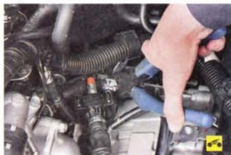
24. Сожмите отогнутые ушки хомута крепления к трубке шланга, подводящего жидкость от корпуса термостата, сдвиньте хомут по шлангу и отсоедините шланг от трубки.
