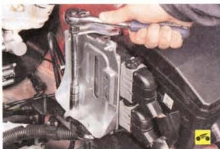
13. Выверните два болта крепления блока управления двигателем и отведите блок в сторону.
