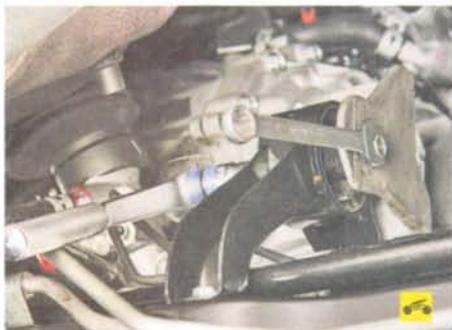
44. Отсоедините заднюю опору силового агрегата от кронштейна коробки передач, отвернув гайку болта ее крепления к кронштейну и вынув болт (см. «Замена задней опоры силового агрегата и кронштейна ее крепления к силовому агрегату», с. 87).
