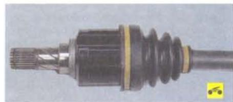
– внутренний шарнир должен перемещаться в угловых и осевых направлениях с легким усилием, при этом не должно ощущаться рывков, заеданий и радиальных люфтов. В противном случае замените внутренний шарнир;
