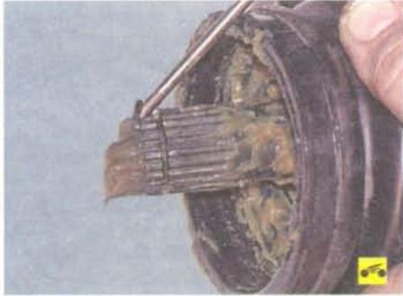
8. Снимите стопорное кольцо, выведя его отверткой из проточки вала.
