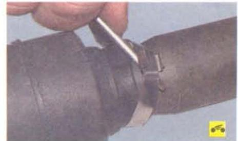
Динамический демпфер, закрепленный хомутом на валу привода, при эксплуатации обычно не выходит из строя. В случае замены вала новым, на котором не установлен демпфер, для его снятия достаточно снять хомут крепления так же, как это делали при снятии хомутов чехлов шарниров...
