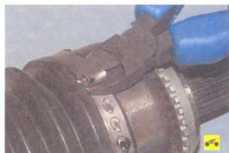
3. Отсоедините отверткой или перекусите бокорезами замок хомута крепления чехла наружного шарнира и снимите хомут.
