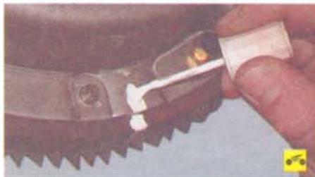
2. Если предполагается установка прежнего нажимного диска, пометьте любым способом (например, краской) взаимное расположение кожуха диска и маховика, чтобы установить нажимной диск в прежнее положение (для сохранения балансировки).
