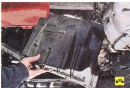
16. ...и левый брызговики двигателя (см. «Снятие и установка брызговиков и защиты картера двигателя», с. 85).
