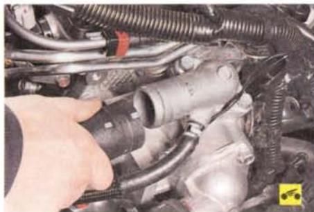
18. Слейте охлаждающую жидкость, отсоедините и снимите трубки системы охлаждения, подведенные к корпусу термостата (см. «Снятие и установка корпуса термостата в сборе», с. 105).
