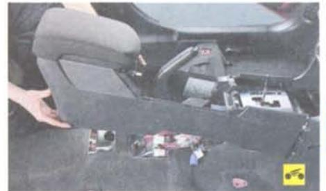
11. ...и облицовку тоннеля пола с подлокотником (см. «Снятие и установка облицовки тоннеля пола», с. 247).
