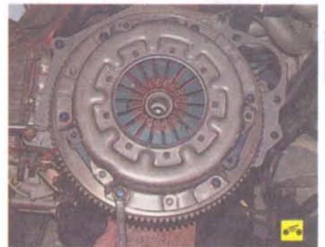
4. ...выверните шесть болтов крепления кожуха нажимного диска сцепления к маховику. Затяжку болтов ослабляйте равномерно: каждый болт по одному обороту ключа, переходя от болта к болту по диаметру.
