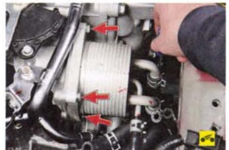
15. Выверните четыре болта крепления теплообменника к картеру вариатора.
