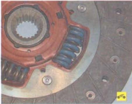
7. Проверьте надежность фиксации демферных пружин в гнездах ступицы ведомого диска, пытаясь переместить их в гнездах ступицы рукой. Если пружины легко перемещаются в гнездах или сломаны, замените диск.
