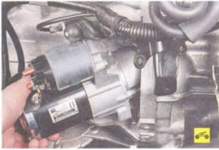
29. Снимите стартер с двигателя (см. «Снятие и установка стартера», с. 195).
