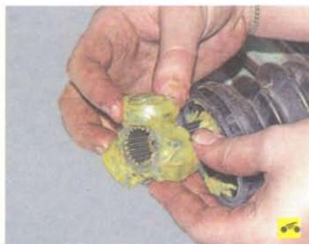
16. Снимите со шлицев вала ступицу с роликами, а с вала защитный чехол.
