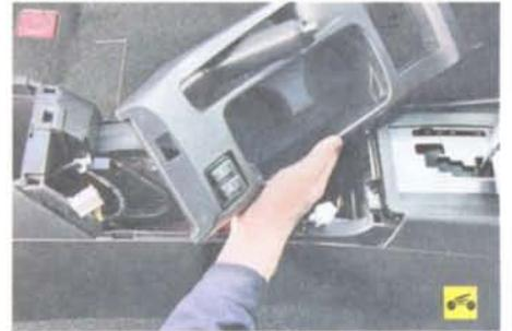
10. Снимите верхнюю облицовочную панель тоннеля пола...
