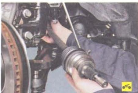
16. ...и снимите привод.
