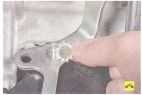
38. Снимите установленную под гайкой зубчатую шайбу...
