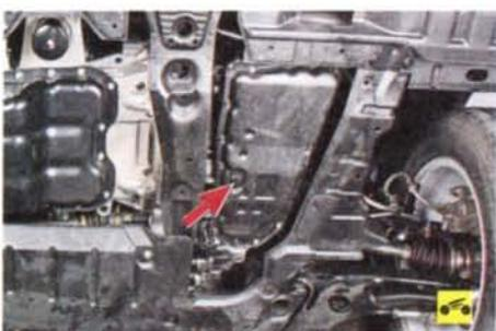
17. Слейте масло из коробки передач (на фото показана пробка сливного отверстия вариатора), см. «Проверка уровня и замена рабочей жидкости в вариаторе (CVT)», с. 68.
