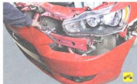
4. Снимите передний бампер (см. «Снятие, разборка и установка переднего бампера», с. 230).
