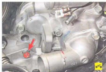
53. Выверните болты крепления коробки передач к двигателю, предварительно подставив под коробку передач надежную опору.
