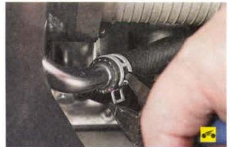
13. Сожмите пассатижами ушки хомута крепления шланга теплообменника вариатора к трубке системы охлаждения, сдвиньте хомут вдоль шланга...
