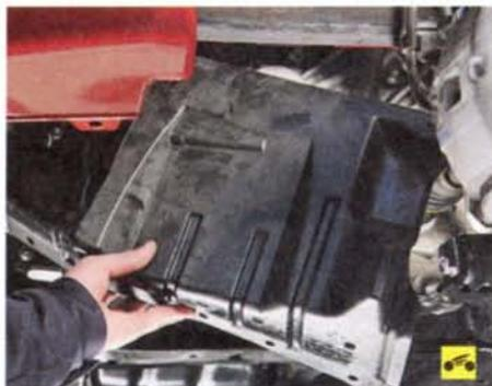
10. ...и правый брызговики двигателя (см. «Снятие и установка брызговики и защиты картера двигателя», с. 85).
