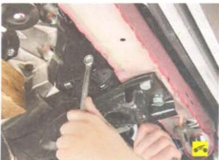
45. Придерживая ключом, отверните гайку болта крепления передней опоры двигателя к кронштейну защитного бруса.
