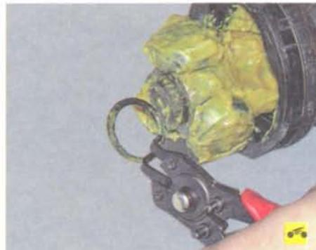
15. Снимите стопорное кольцо ступицы шарнира, разжав его съемником стопорных колец и выведя кольцо из проточки вала.
