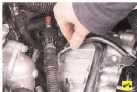
25. Снимите шланг с патрубка сапуна коробки передач...
