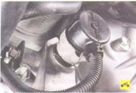
31. Поддев отверткой, извлеките пружинный фиксатор колодки жгута проводов управления вариатором и отсоедините колодку от разъема.
