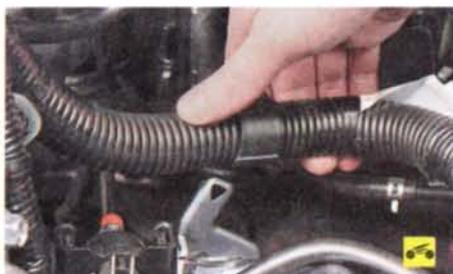
22. ...и снимите жгут с кронштейна картера коробки передач.
