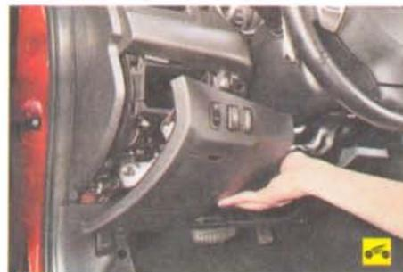
4. Снимите облицовку под рулевой колонкой (см. «Снятие и установка панели приборов», с. 249).
