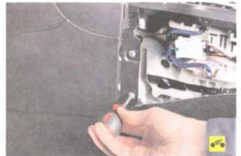
12. Выверните два задних винта крепления левой облицовочной панели центральной консоли панели приборов...
