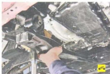
48. ...и снимите брус с автомобиля.
