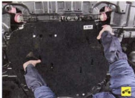
8. Вывернув четыре болта, снимите защиту двигателя...
