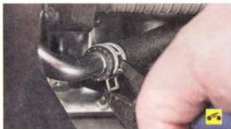
19. Сожмите пассатижами ушки хомута крепления шланга теплообменника вариатора к трубке системы охлаждения, сдвиньте хомут вдоль шланга...
