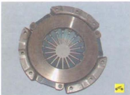
9. Осмотрите рабочие поверхности трения маховика и нажимного диска, обратив внимание на отсутствие глубоких рисок, задигов, забоин, явных следов износа и перегрева. Замените дефектные узлы.
