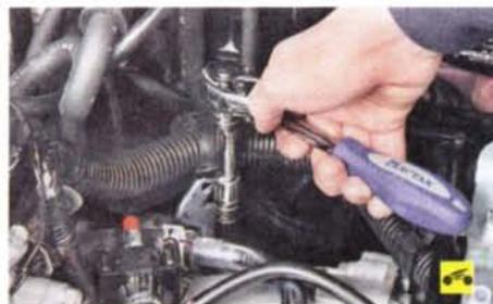
23. Выверните задний болт крепления трубки системы охлаждения.
