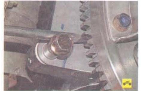
3. Удерживая маховик большой отверткой (или монтажной лопаткой) от проворачивания...
