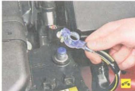
3. Отсоедините провод от клеммы «минус» аккумуляторной батареи
