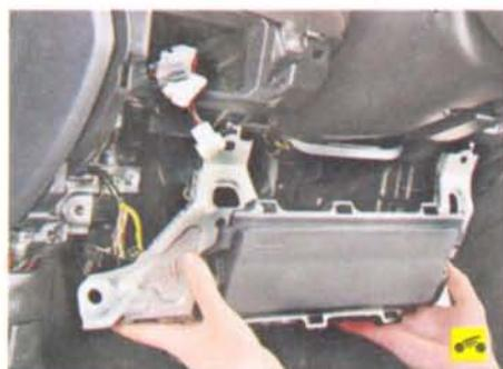
5. Снимите «коленную» подушку безопасности (см. «Снятие и установка подушки безопасности для защиты водителя», с. 249).
