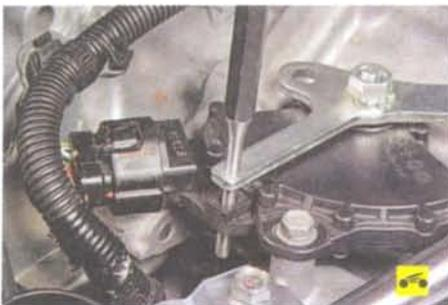
3. Зафиксируйте механизм переключения режимов.
