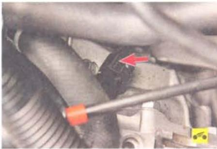
30. Отсоедините колодку жгута проводов от датчика скорости.
