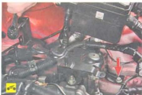
50. Отверните гайку и выверните болт крепления кронштейна воздушного фильтра и блока управления двигателем...
