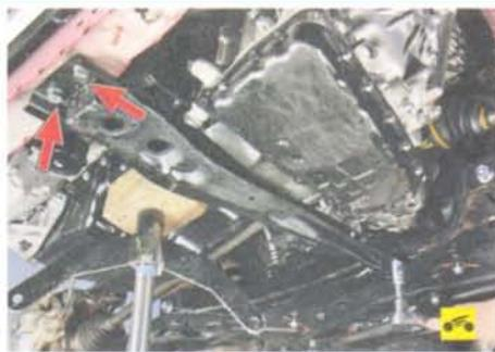
47. Выверните три болта крепления защитного бруса силового агрегата...
