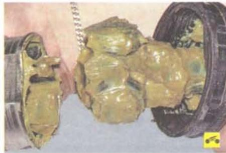
14. Отсоедините от привода корпус внутреннего шарнира.
