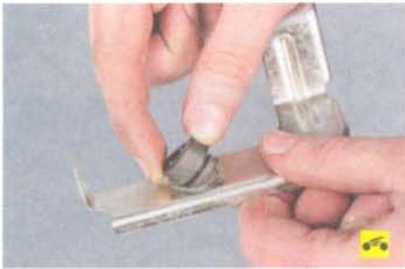
13. ...и выньте резиновую втулку из отверстия кронштейна. Сильно обжатую или затвердевшую втулку замените новой.
