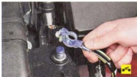
3. Отсоедините провод от клеммы «минус» аккумуляторной батареи.
