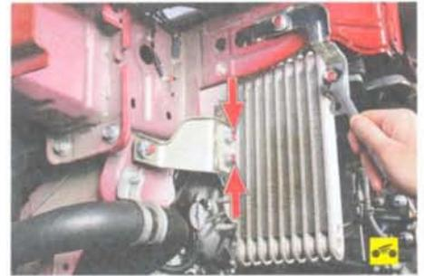
8. Выверните три болта крепления радиатора к кронштейну кузова...
