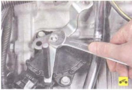
33. Отверните гайку крепления наконечника троса привода управления коробкой передач...
