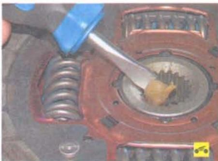
14. На шлицы ступицы ведомого диска нанесите тугоплавкую консистентную смазку.
