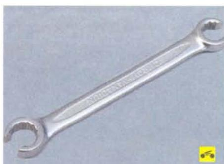
– специальный ключ для гаек тормозных трубопроводов;
