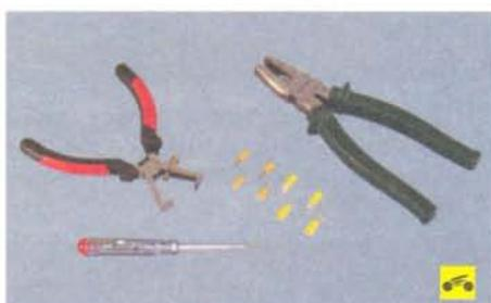
– при проведении работ с системой электрооборудования необходимы специальные пассатики для обжимания клемм и штекеров, приспособление для зачистки проводов, индикаторная отвертка и набор клемм различных типоразмеров;
