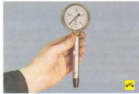
– компрессометр для диагностики технического состояния двигателя путем определения компрессии в цилиндрах;
