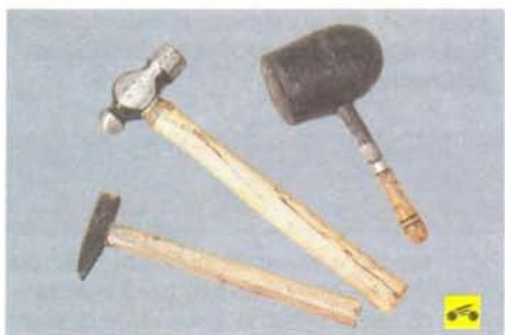
– молотки разных размеров с металлическими и резиновыми бойками (последние необходимы при проведении рихтовочных работ);
