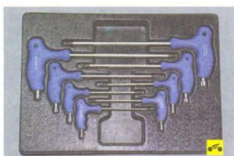
– набор торцовых ключей TORX (наиболее часто используемые – T25 и T30);
