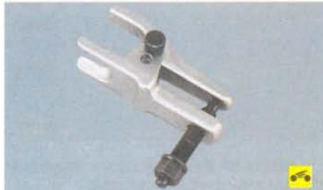
– съемник для выпрессовки пальцев шаровых шарниров подвески и наконечников рулевых тяг;
