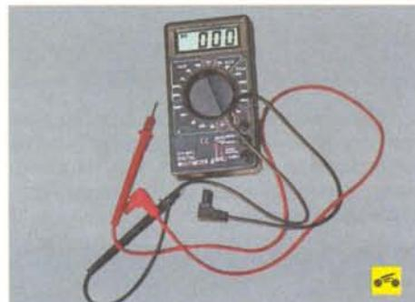
– автомобильный тестер, используемый при ремонте электрических цепей и для проверки технического состояния приборов электрооборудования;
