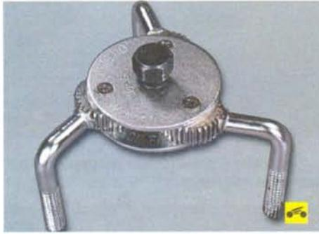
– специальный ключ для масляного фильтра, его используют в том случае, если фильтр не удается отвернуть руками;
