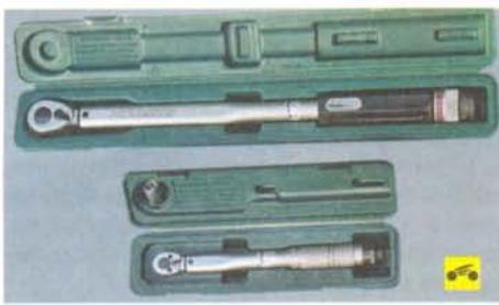
– динамометрические ключи для соблюдения точного момента затяжки ответственных резьбовых соединений, желательно иметь ключи с пределом измерений от 5 до 200 Н·м;
