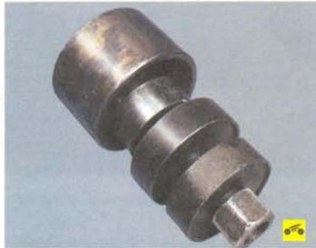
– приспособление для выпрессовки и запрессовки подшипников ступиц передних и задних колес;
