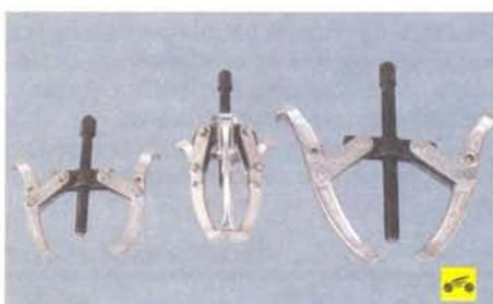
– набор универсальных съемников разных размеров для выпрессовки подшипников и других деталей.
