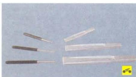
– кернеры разных размеров (необходимы при проведении сверлильных работ), набор зубил (можно использовать для того, чтобы законтрить гайку или срубить такую, которую невозможно отвернуть);
