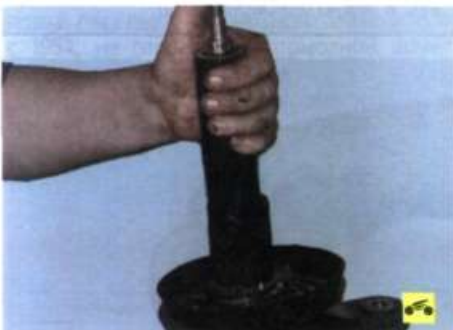
12. ...и извлеките амортизатор из корпуса стойки.
