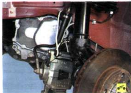
7. Ослабьте затяжку трех гаек крепления верхней опоры.
