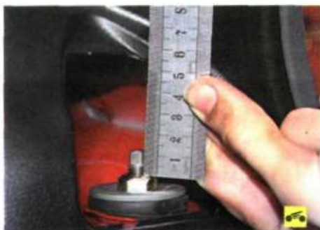
13. Установите амортизатор в порядке, обратном снятию. Гайку верхнего и болт нижнего креплений амортизатора окончательно затягивайте на автомобиле, стоящем на земле. Опустив автомобиль на землю, несколько раз сильно качните его. Затяните болт нижнего крепления
