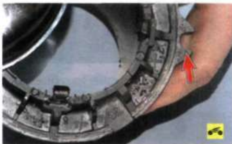
2. Снимите пружинный фиксатор гайки пальца шаровой опоры.
