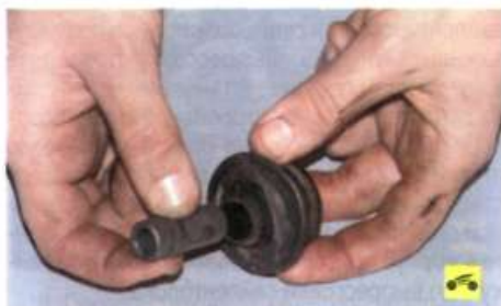
11. Извлеките распорную втулку из подушки.
