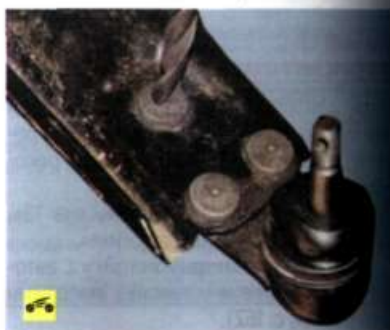
4. ...установите съемник шаровых шарниров и выпрессуйте палец из рычага.
