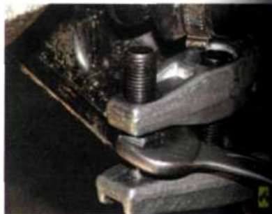
4. ...установите съемник шаровых шарниров и выпрессуйте палец из рычага.
