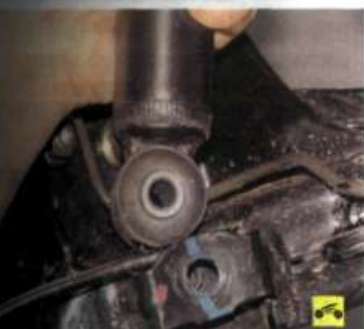
8. Отверткой извлеките проушину амортизатора из кронштейна...
