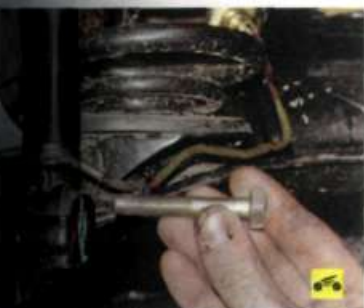
7. ...и извлеките его из проушин амортизатора и кронштейна.
