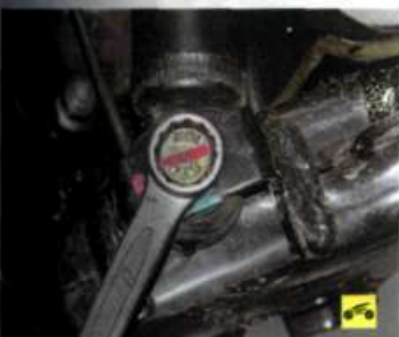
6. Выверните болт нижнего крепления амортизатора...
