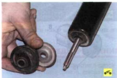
10. Снимите со штока амортизатора нижнюю резиновую подушку в сборе с распорной втулкой и шайбой.
