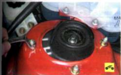
7. Ослабьте затяжку трех гаек крепления верхней опоры.
