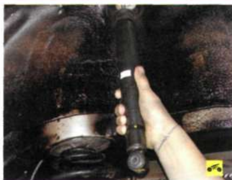
9. ...и снимите амортизатор с автомобиля.
