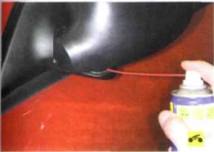
8. Шарнир наружного зеркала (силиконовая смазка в аэрозольной упаковке).
