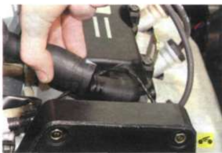
4. ...и снимите шланг с патрубка.
