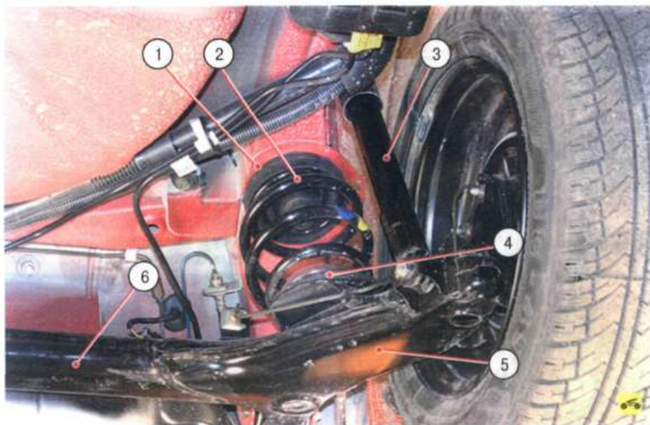
Рис. 4.3. Расположение элементов задней подвески на автомобиле: 1 – верхняя прокладка пружины; 2 – пружина задней подвески; 3 – амортизатор; 4 – нижняя прокладка пружины; 5 – рычаг задней подвески; 6 – балка задней подвески
