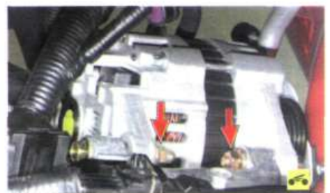
2. Ослабьте болт крепления генератора к натяжной планке...
