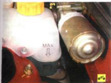
Расширительный бачок установлен в подкапотном пространстве с левой стороны.
