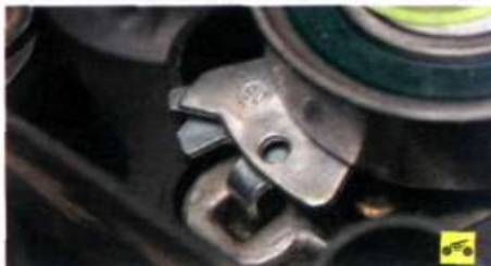
Рис. 4.7. Схема контроля натяжения ремня привода газораспределительного механизма: а – положение натяжителя при регулировке натяжения ремня; б – положение натяжителя при контроле совпадения установочных меток на шкивах коленчатого и распределительного валов; 1 – кронштейн натяжного ролика; 2 – подвижная планка натяжителя; 3 – ролик натяжителя; 4 – ремень привода газораспределительного механизма; А – установочное отверстие натяжителя
