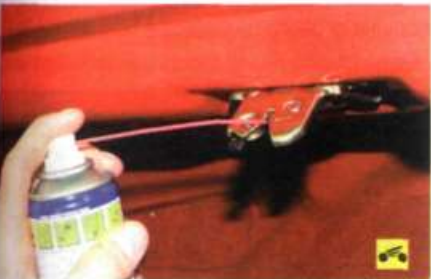
9. Зашелка замка (силиконовая смазка в аэрозольной упаковке)...
