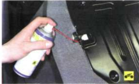
13. Рекомендуем также смазывать фиксаторы спинки заднего сиденья (моторное масло).
