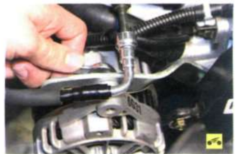
2. Ослабьте болт крепления генератора к натяжной планке...
