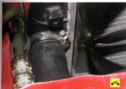
5. ...соединения отводящего шланга с патрубком радиатора...
