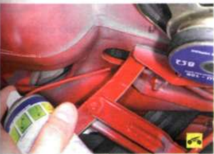
10. ...и петли крышки багажника (моторное масло).
