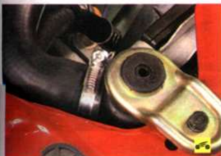
3. Осмотрите соединения подводящего шланга с радиатором...
