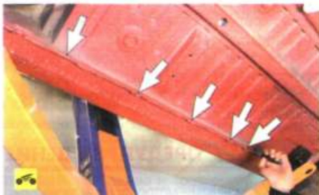
1. Прочищайте дренажные отверстия в каждом пороге.
