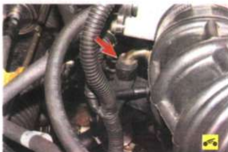
9. ...и отводящим штуцерами дроссельного узла. В случае подтекания охлаждающей жидкости замените хомуты крепления шлангов.
