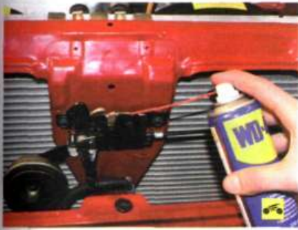
7. ...и замок капота (моторное масло).
