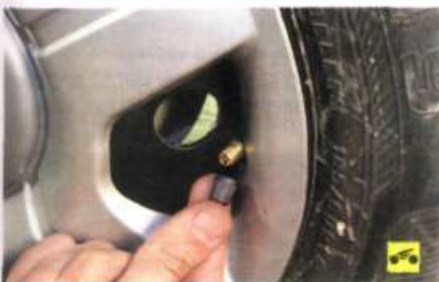
1. Отверните колпачок от вентиля.
