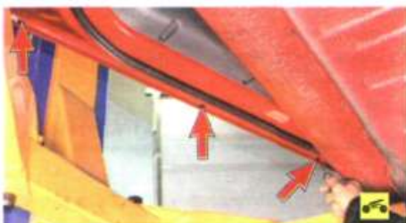
1. Прочищайте дренажные отверстия в каждом пороге.
