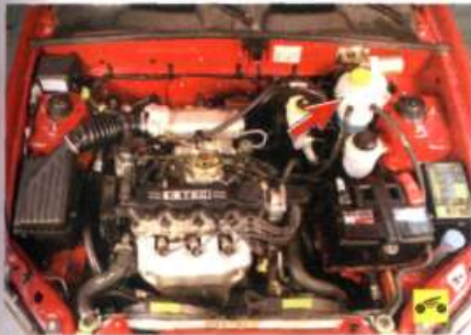
Расширительный бачок установлен в подкапотном пространстве с левой стороны.
