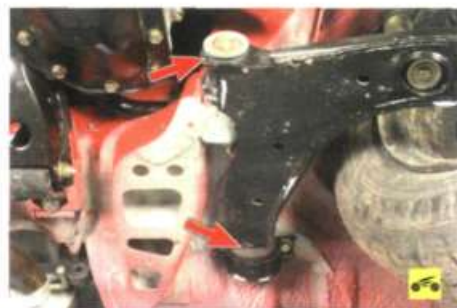
Рис. 4.2. Расположение элементов передней подвески на автомобиле: 1 – передний шарнир (сайлентблок) рычага передней подвески; 2 – амортизаторная стойка; 3 – пружина передней подвески; 4 – шаровая опора стойки; 5 – стойка стабилизатора поперечной устойчивости; 6 – штанга стабилизатора поперечной устойчивости; 7 – задний шарнир (сайлентблок) рычага передней подвески; 8 – рычаг передней подвески
