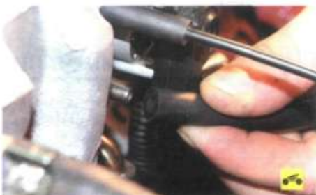
4. ...и снимите шланг с патрубка.
