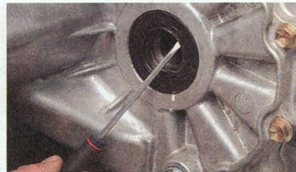
...извлекаем сальник, поддев его отверткой.
