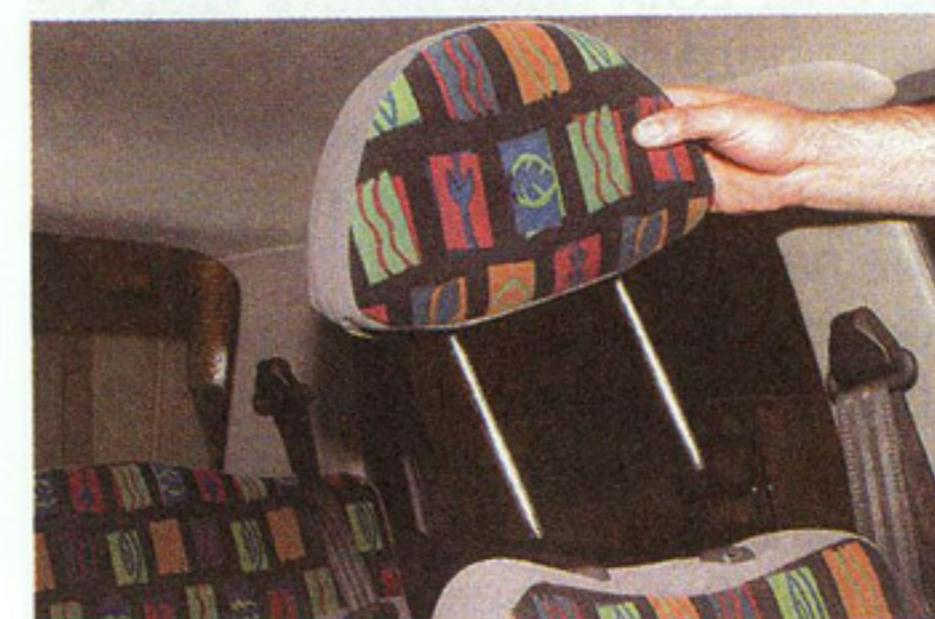
Выводим стойки подголовника из отверстий в спинке сиденья. Чтобы установить подголовник, вставляем стойки подголовника в отверстия в спинке сиденья и перемещаем подголовник вниз (нажимать при этом на пружинную пластину фиксатора не требуется).
