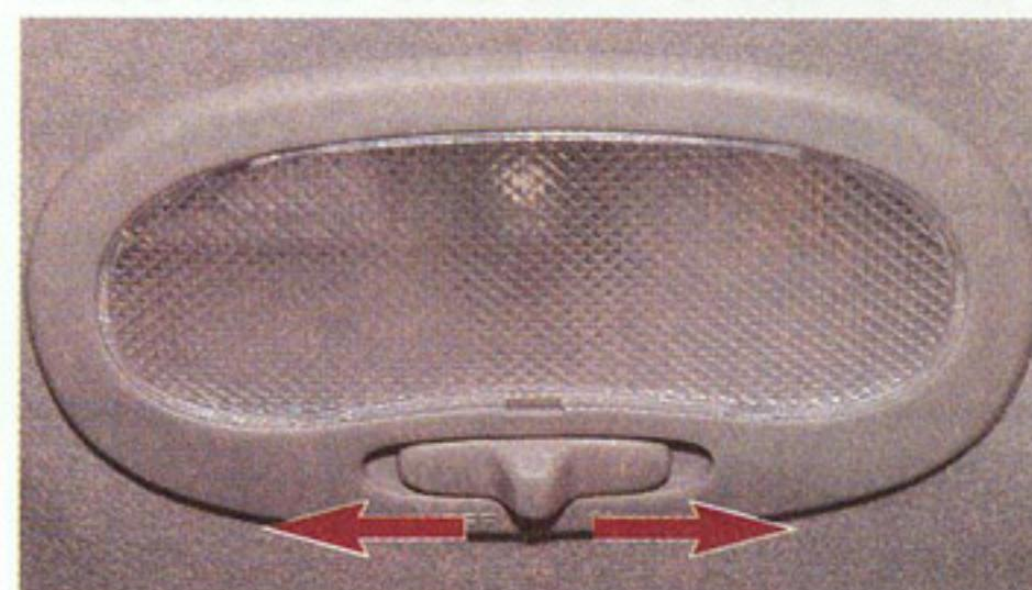
**Плафон освещения салона установлен в передней части обивки потолка над внутрисалонным зеркалом заднего вида.**
