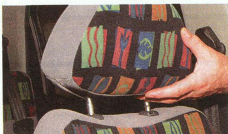
Для того чтобы поднять или опустить подголовник, тянем его вверх или опускаем до одного из фиксированных положений.
