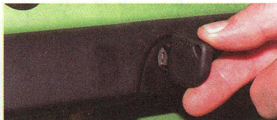
...поворачиваем его по часовой стрелке и слегка приподнимаем дверь, после чего под действием газонаполненных упоров она откроется полностью.
