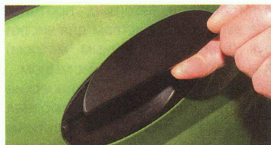
Для того чтобы открыть дверь снаружи, поднимаем ручку и тянем дверь на себя.
