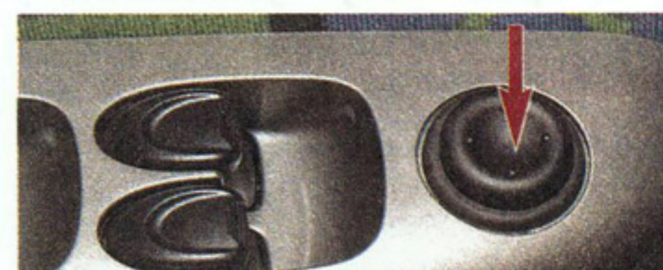
**Регулировка положения зеркала с электроприводом проводится при включенном зажигании джойстиком, расположенным на подлокотнике водительской двери.**
