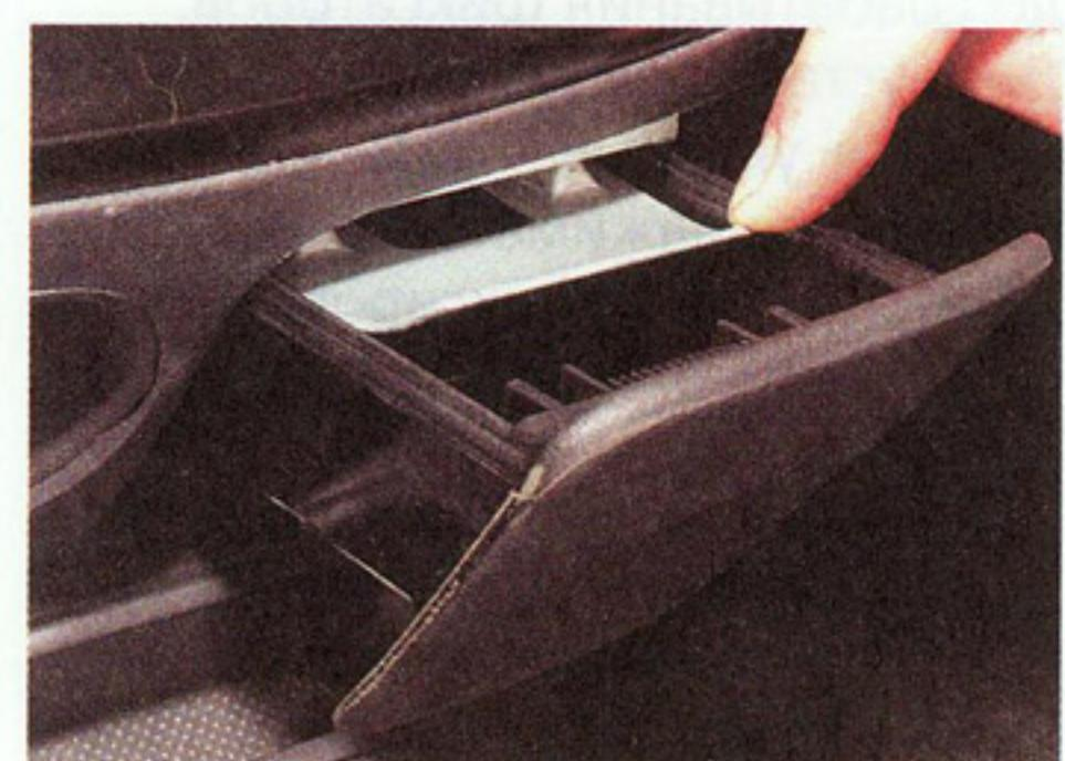
...нажимаем на верхнюю подпружиненную пластину...
