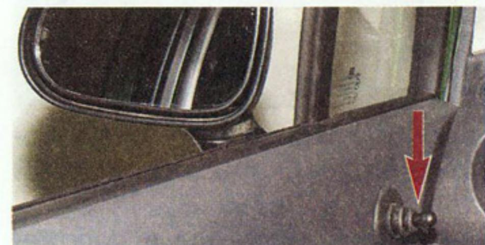
**Регулировка положения зеркала проводится изменением положения рычага, расположенного на внутренней стороне водительской двери.**
