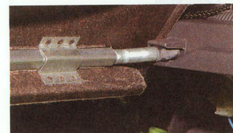
Выводим концы оси задней полки из пазов...
