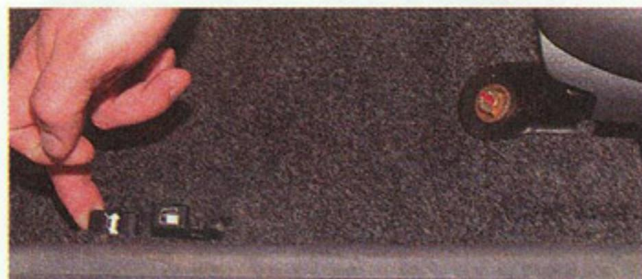
...в салоне тянем вверх рычаг привода замка двери задка, расположенный на полу рядом с левым порогом.
