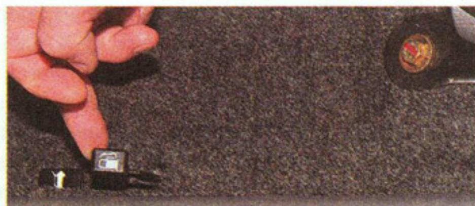
...тянем вверх рычаг привода замка крышки лючка заливной горловины, расположенный на полу рядом с левым порогом.
