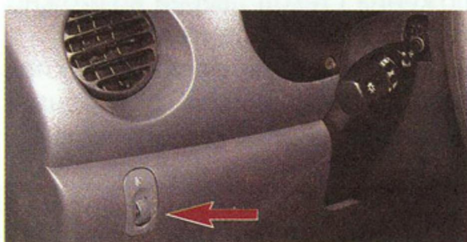
**Регулятор расположен на панели приборов слева от рулевой колонки (показан стрелкой).**
