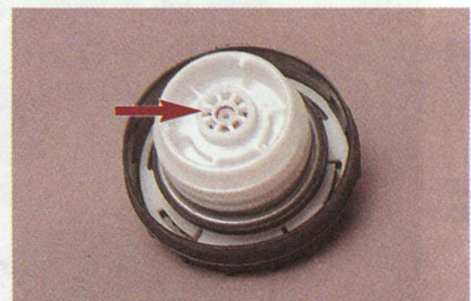
В пробке заливной горловины топливного бака установлены впускной и выпускной клапаны вентиляции бака.
