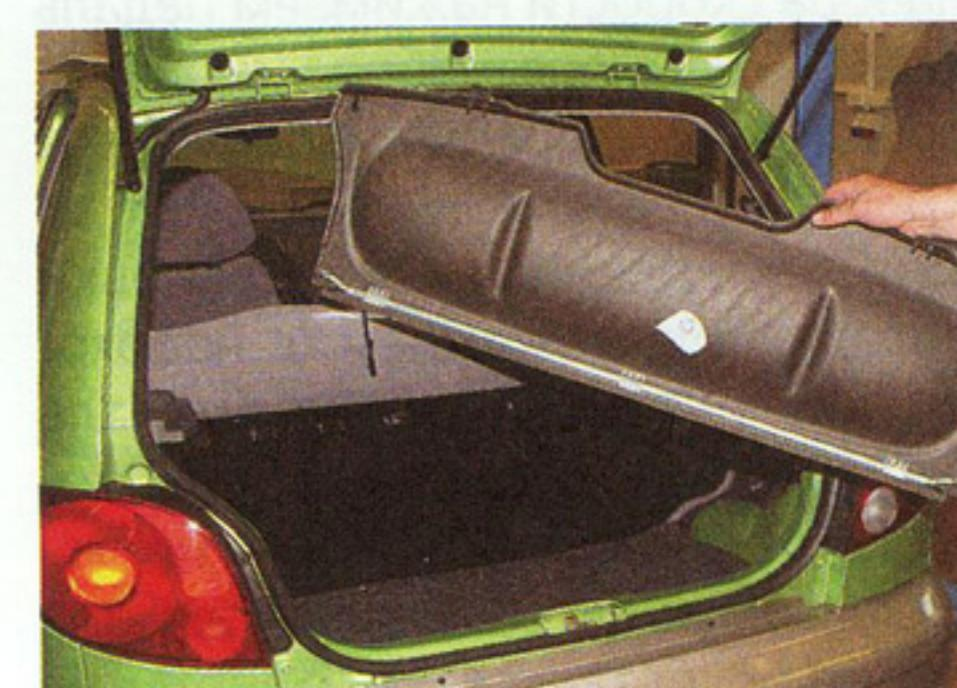
...и снимаем заднюю полку.
