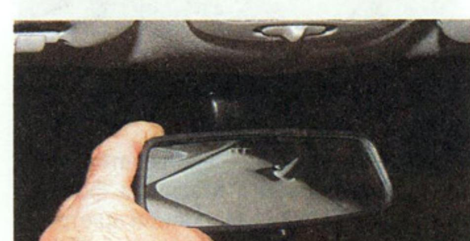
**...поворачивая его корпус на шарнире.**
