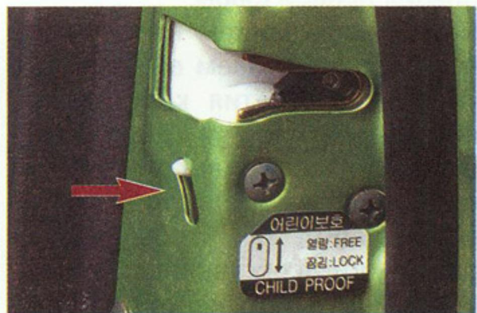
Для блокировки внутренней ручки двери переводим в нижнее положение пластмассовый рычаг блокиратора, расположенный на внутренней стороне задней двери (показан стрелкой).
