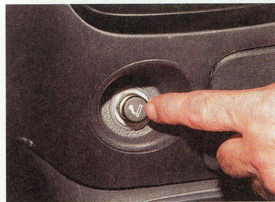
**...и нажимаем рукоятку прикуривателя до срабатывания фиксатора.**
