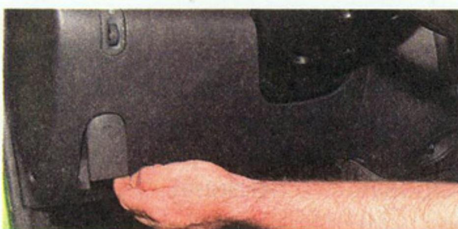
Чтобы открыть капот, в салоне автомобиля тянем на себя ручку привода замка капота, расположенную слева в нижней части панели приборов.
