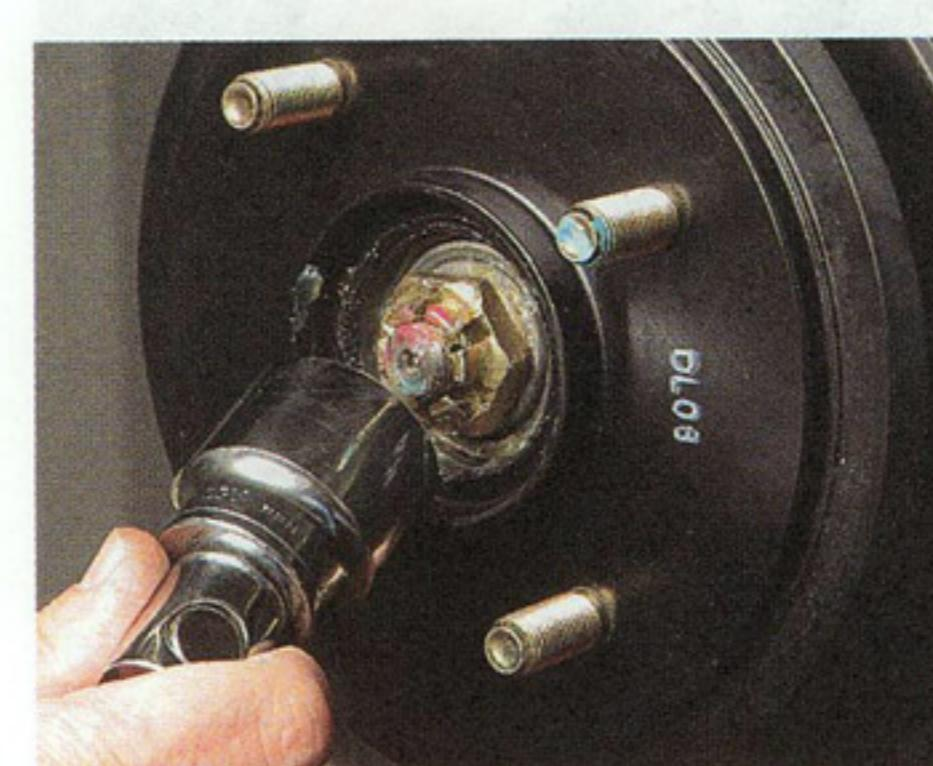
Головкой «на 30» отворачиваем корончатую гайку.
