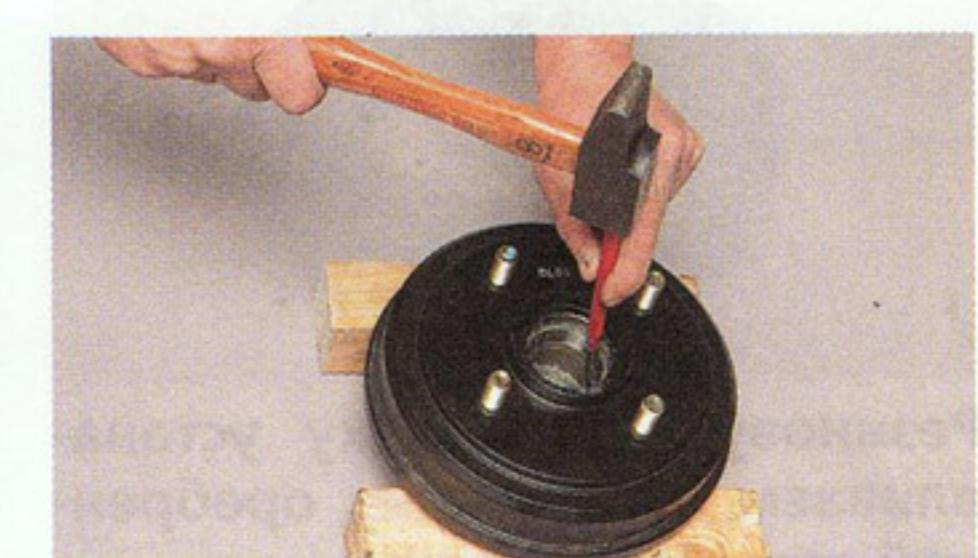
Устанавливаем тормозной барабан на деревянные бруски и, нанося удары через выколотку по наружному кольцу внутреннего подшипника...
