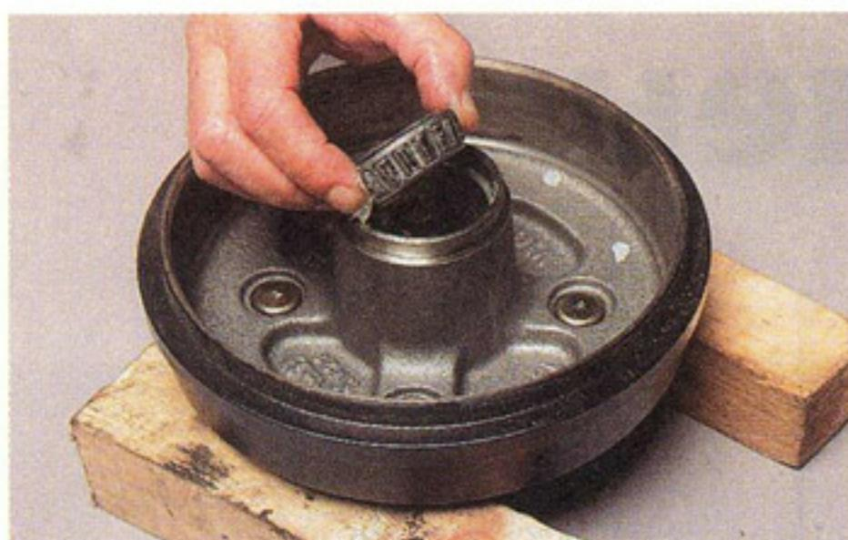
**...внутреннее кольцо с роликами и сепаратором в сборе внутреннего подшипника...**
