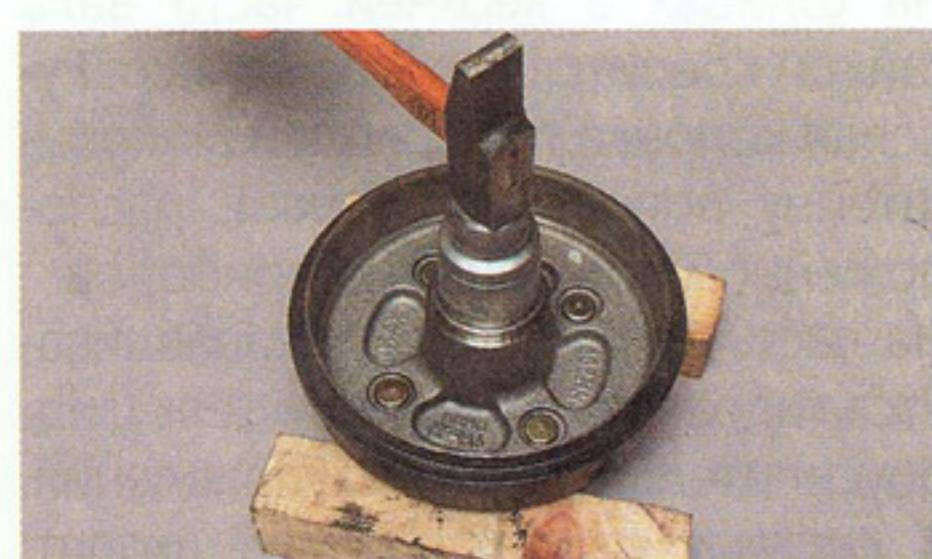
**Используя отрезок трубы или головку подходящего диаметра, запрессовываем наружное кольцо внутреннего подшипника в тормозной барабан до упора.**
