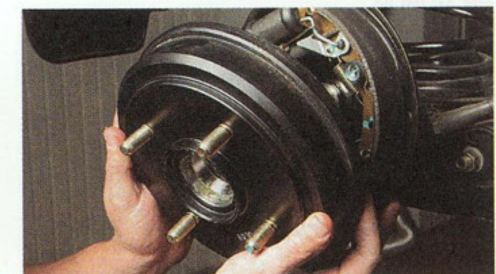
Снимаем тормозной барабан в сборе с наружным кольцом наружного подшипника, внутренним подшипником и сальником.
