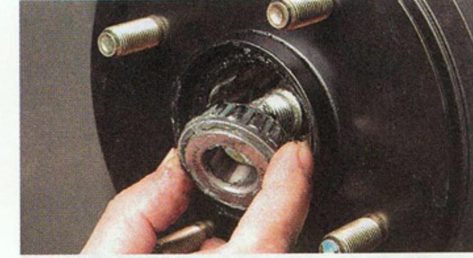
...и внутреннее кольцо наружного подшипника в сборе с сепаратором и роликами.
