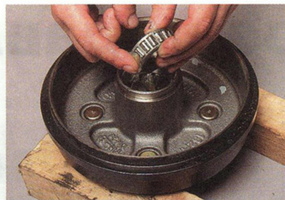
**...и на поверхность роликов внутреннего кольца внутреннего подшипника равномерно наносим пластичную смазку.**
