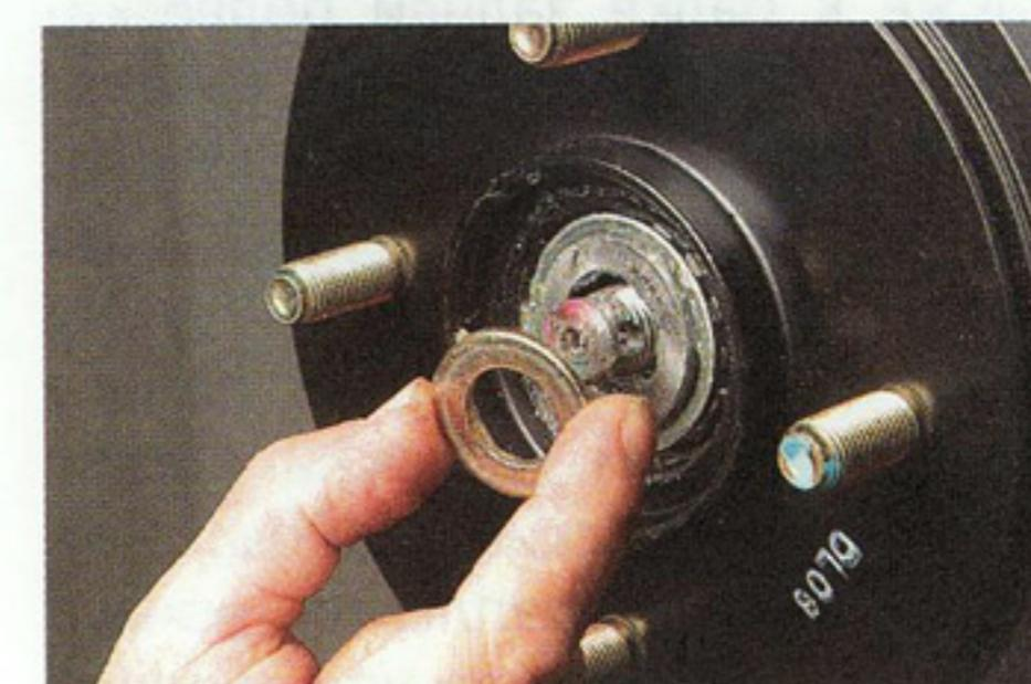
Снимаем с цапфы плоскую шайбу...
