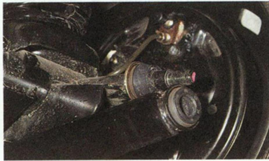
Снимаем проушину штанги со шпильки.
