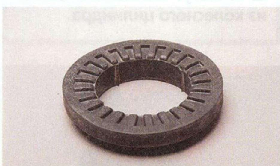
**Резиновую прокладку устанавливаем на пружину оребренной стороной вверх.**
