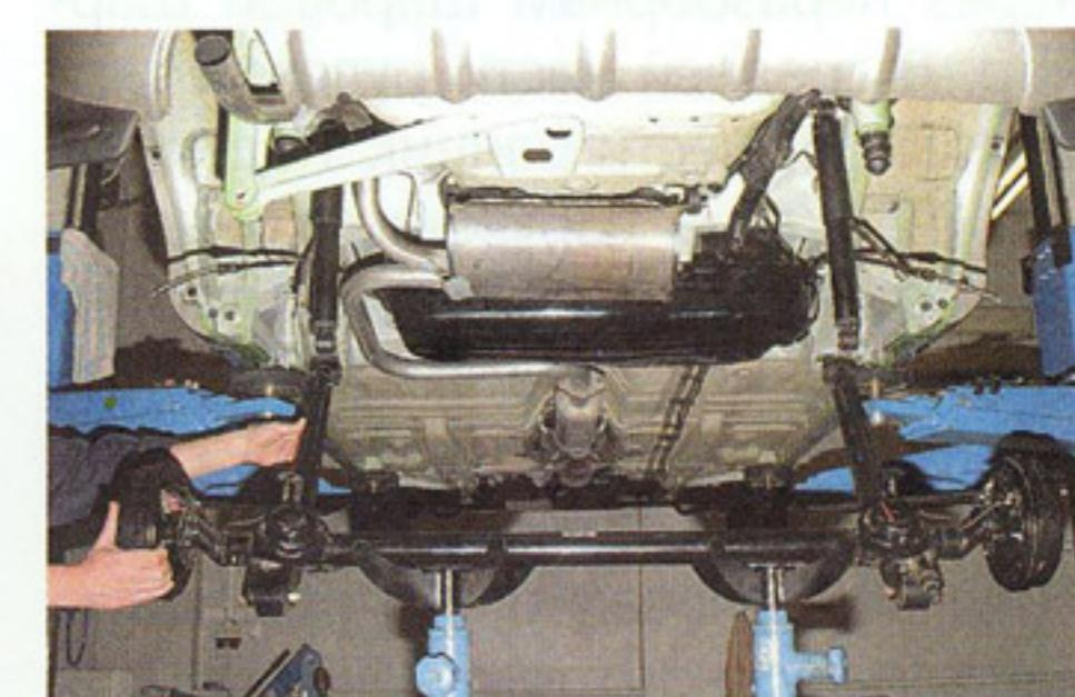
**Снимаем заднюю подвеску.**
